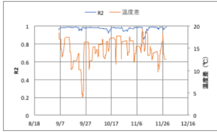
図9 評価期間96時間の変化油圧ディスクにおける温度差と決定係数(R 2 )の変化
