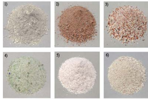
写真1 細骨材として用いた各種材料 1)かき殻、2)廃瓦破砕材、3)陶磁器屑破砕材、 4)ガラス破砕材、5)ホタテ殻、6)サンゴ砂
