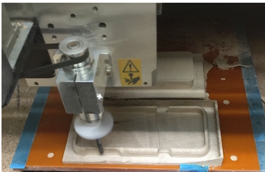
(b) ケース側面の切削の様子
