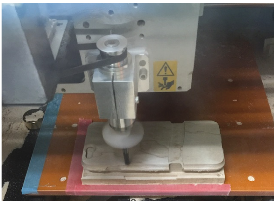
(a) ケース背面の切削の様子
