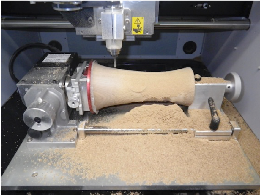
図 2.7: 3次元プロッタを用いた木地の切削の様子
