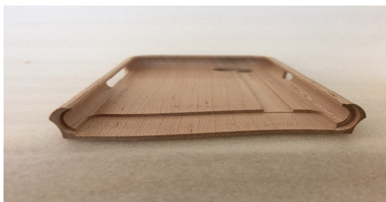
(b) ケース側面の切削の様子
