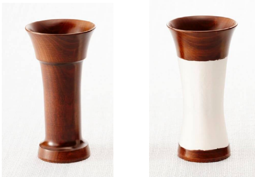
(a) 握り方のかたどりに使用する木地 (b) 木地に印象材を巻き付けた様子
