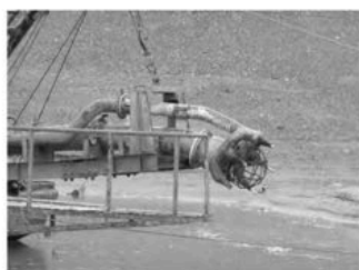
写真21 砂利採取船の軸先。軸先の掘削装置の先端には高圧水を噴射するノズルがあり、ジェット水流で水底の砂利を掘削して吸い上げる。
