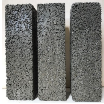
写真－5.4.2 試験体の底部の垂れの状況の例 (設計 V_R = 15\% )
