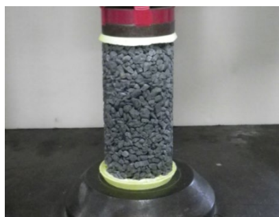
(a) 硫黄で端面をキャッピングした円柱試験体
