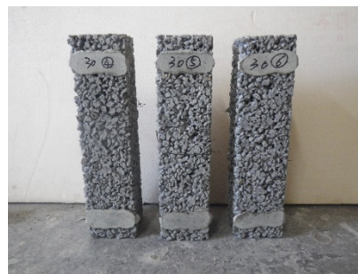
(b) 止水セメントで支点をキャッピングした角柱試験体
