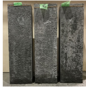
写真－5.4.3 試験体の打込み面の状況の例 (設計 V_R = 0\% )
