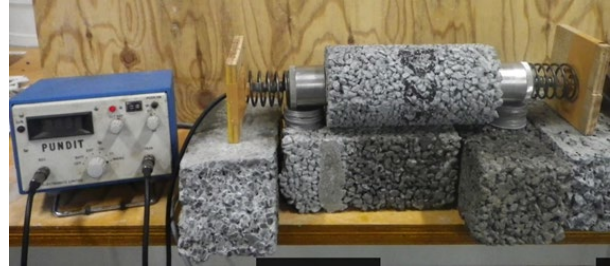
写真-4.3.2 超音波伝播速度の測定の様子
