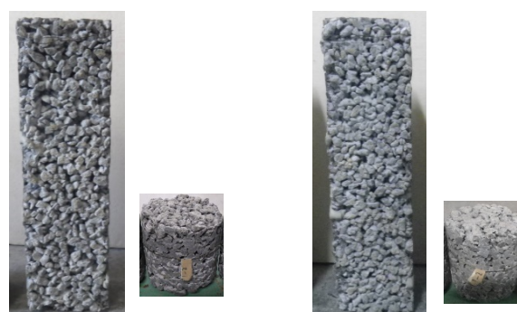
(a) No. 1 (コテ仕上げ) (b) NO. 3 (仕上げ機 1 回)
