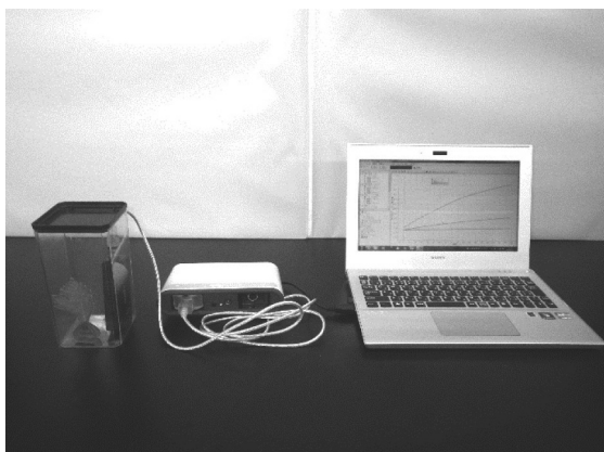
図 1. SPARK データロガー、インターフェイスとパソコンを接続し、植物の葉を入れた容器に気象センサを取り付けた様子。
