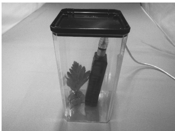
図 2. 気象センサとセロリの葉を入れた測定容器。セロリの葉柄には文具のクリップを取り付け容器内に立たせている。
