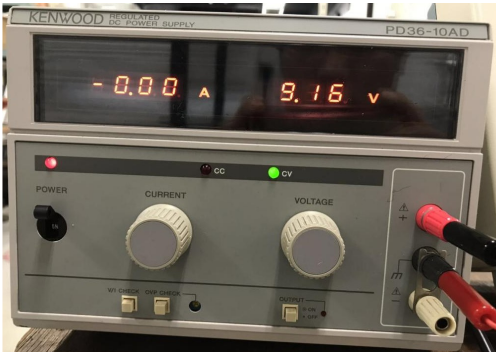
Fig.2.11 DC モータ側に使う直流安定化電源
