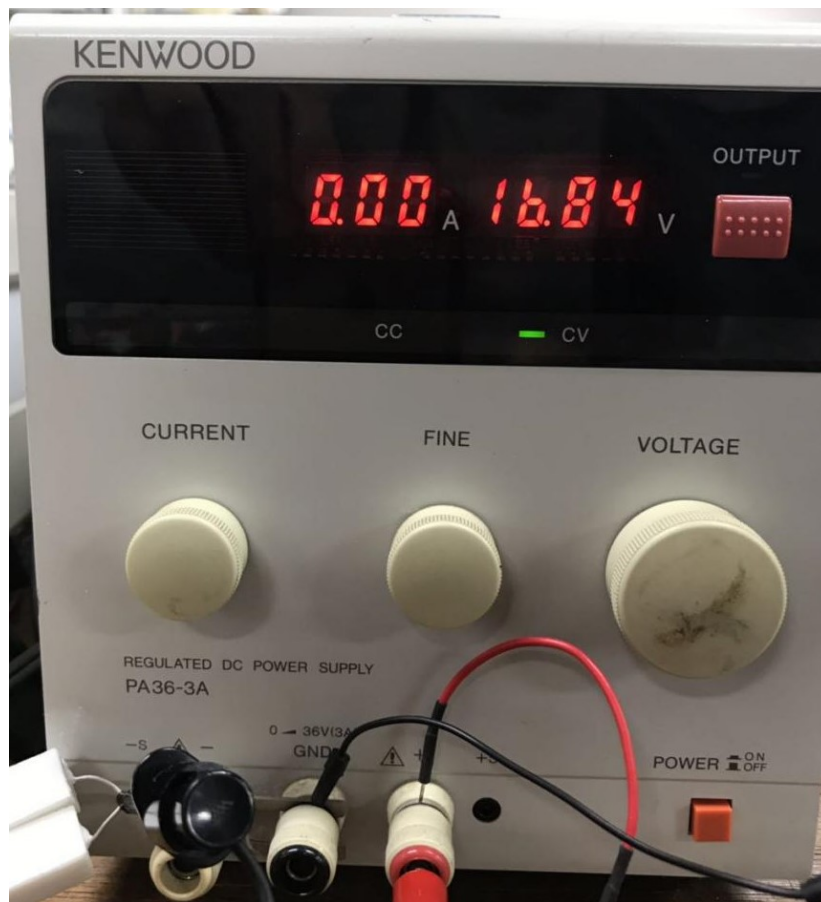
Fig2.12 ブレーキ側に使う直流安定化電源
