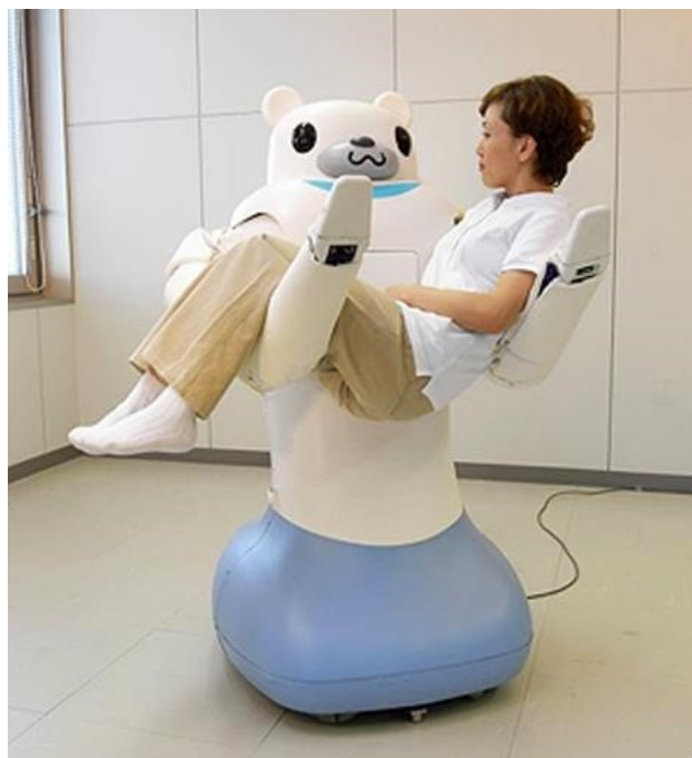
Fig.1.3 アーム直接駆動採用ロボット RIBA [9]
