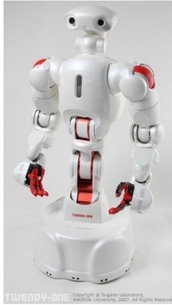
Fig.1.4 直列弾性駆動システム採用ロボット TWENDY-ONE [11]
