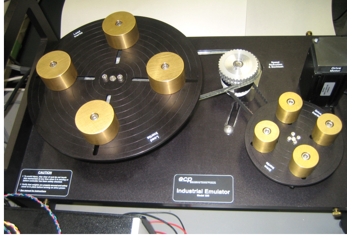
図 5.11: 二慣性共振系実験装置
