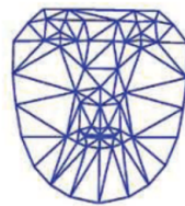
図 1.1: Active Appearance Model のプロトタイプモデル
