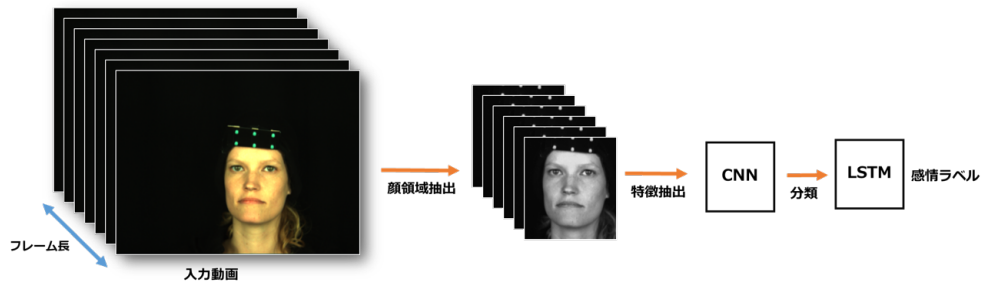
図 4.3: CNN+LSTM の処理の流れ
