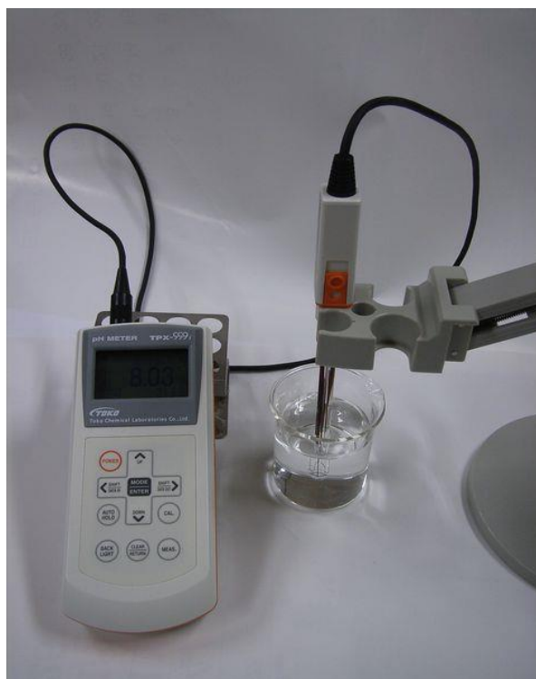
図 2.3 pH メータ計の外観写真
