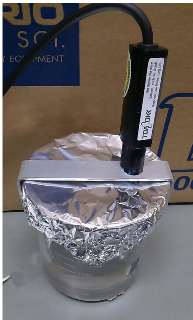
図 2.2 Electrode holder の保管方法
