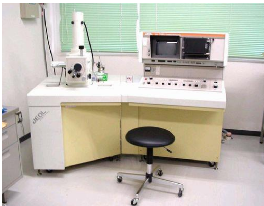
図 2.8 SEM の外観写真
