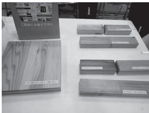
図4. CLT材のサンプル (左：最小規格の厚さ12mmラミナの3層3プライ、右上：標準のフィンガージョイント接合、右下：マイクロフィンガージョイント接合)
