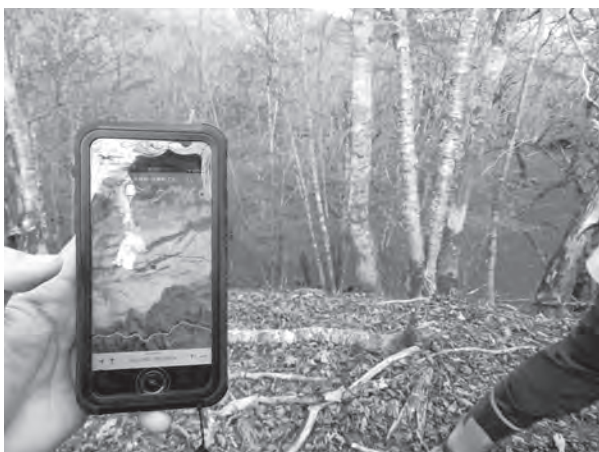
写真1. 現地で線状凹地形（後方崖）を携帯端末に取込んだCS立体図と照らし合わせて確認。
