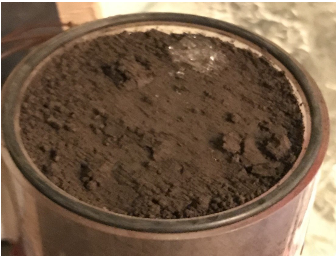
図 3-2-5-4 実験終了後カラム解体したときの様子. 地表面の隆起や氷の生成が確認された.
