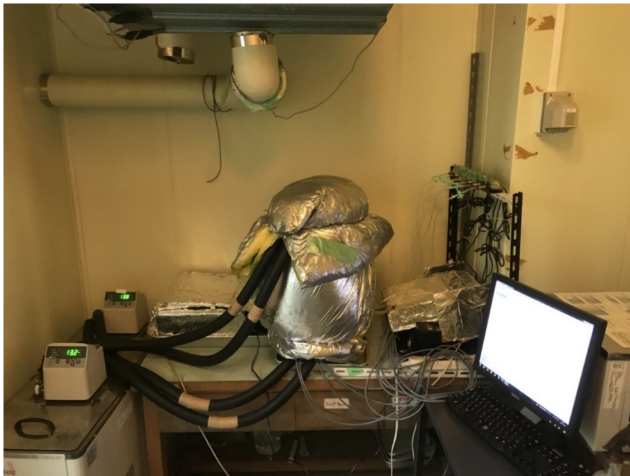
図 3-1-9 グラスウールで断熱した実験装置
