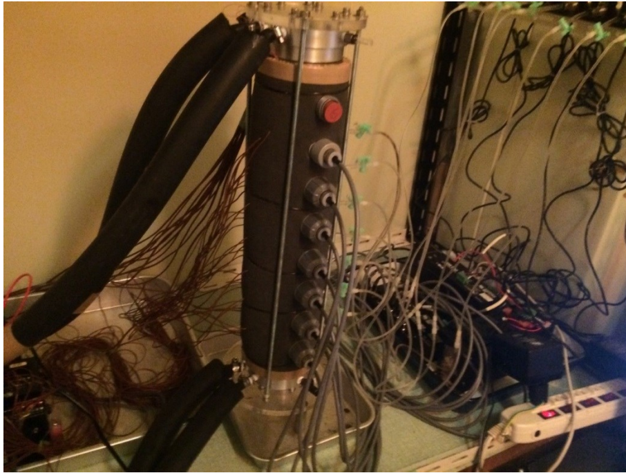
図 3-1-8 ゴムシートで断熱した実験装置
