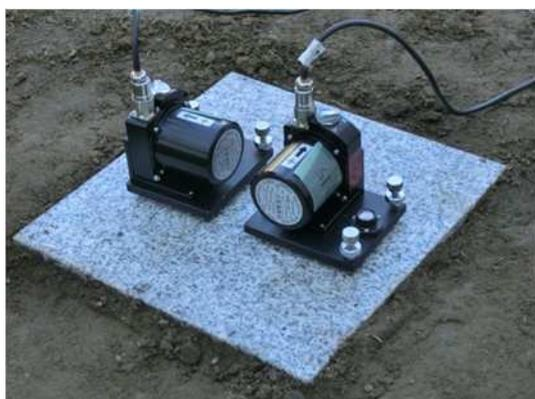
附図 2.6 地盤用速度計設置状況
