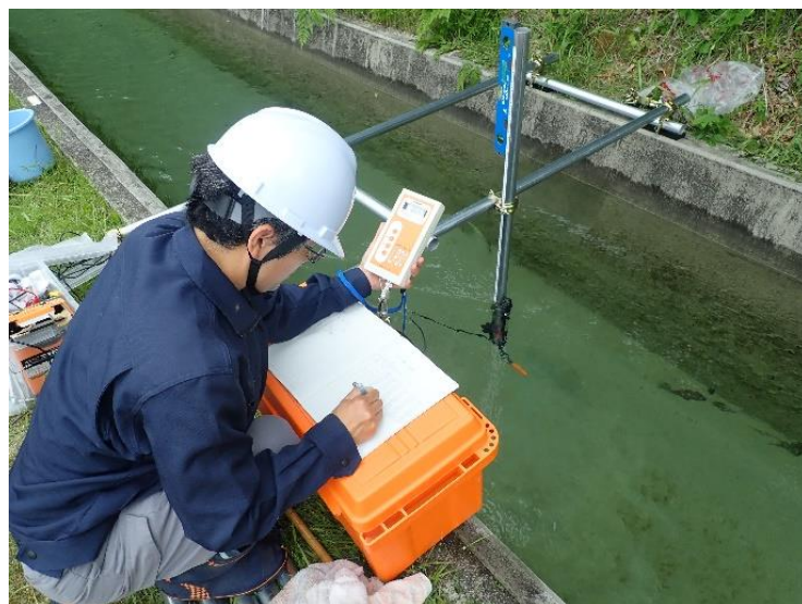
Fig. 5- 2 流速計測の様子
