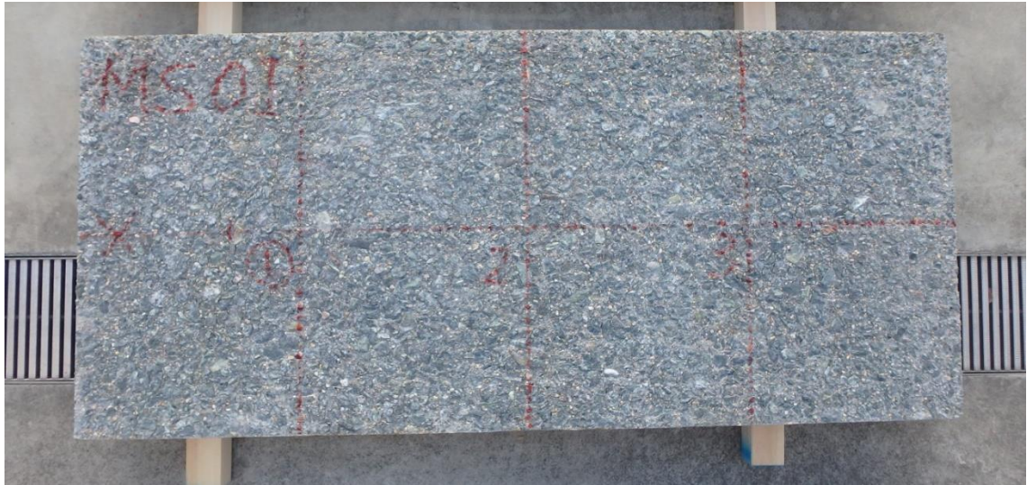
Fig. 6- 4 使用したコンクリートパネル例（粗面1側壁）
