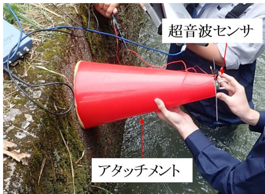
Fig. 7- 2 接触型集音機のイメージ
