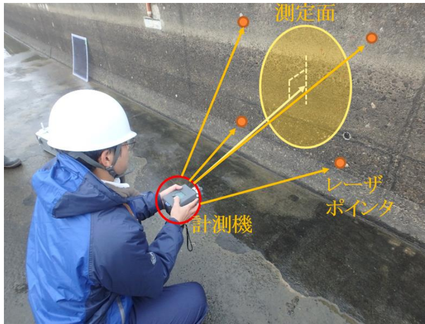
Fig. 7- 1 レーザーポインタによる計測位置決め
