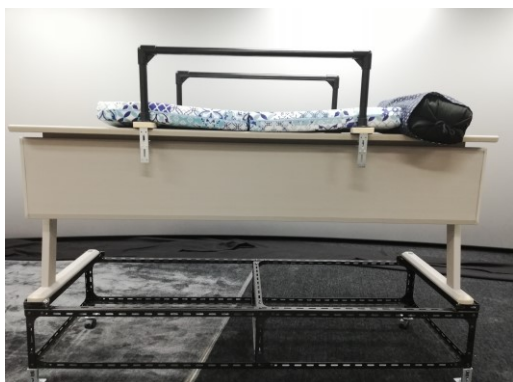
図 2.2-1： 実験で使用した装置の図。被験者は側臥位の場合、左の図のようなテーブルと台の組み合わせた装置を使った。座位の場合は、右の図のようなクッションを付ける椅子を使った。
