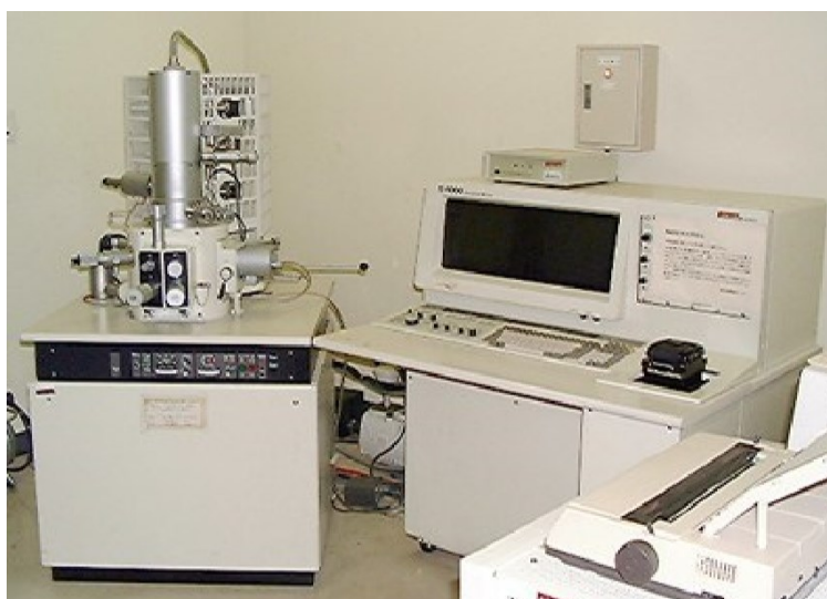
図 2.8 走査型電子顕微鏡（製造：日立 型番：S-4000）
