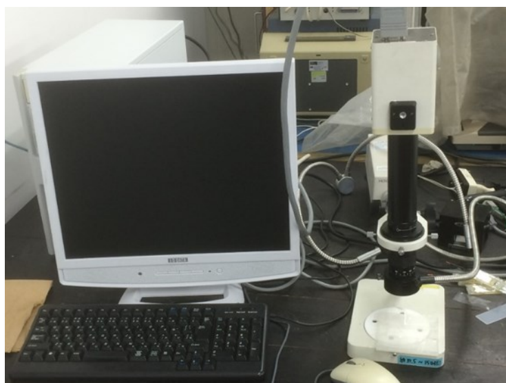
図 2.6 光学顕微鏡（製造：SONIC、型番：DSC04F-560011）
