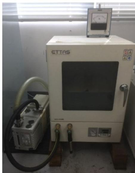
図 2.3 真空脱泡系（上〔製造：ULVAC、型番：GP-S1〕 左下〔製造：EDWARDS、型番：A654-01-904〕 右下〔製造：ETTAS、品番：AVO-310NB〕）
