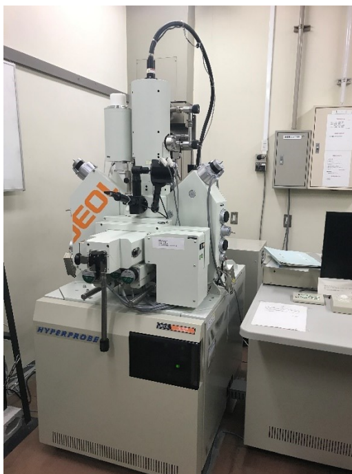
図 2.7 電子プローブ微小分析装置（製造：日本電子(株)、型番：JXA-8530F）
