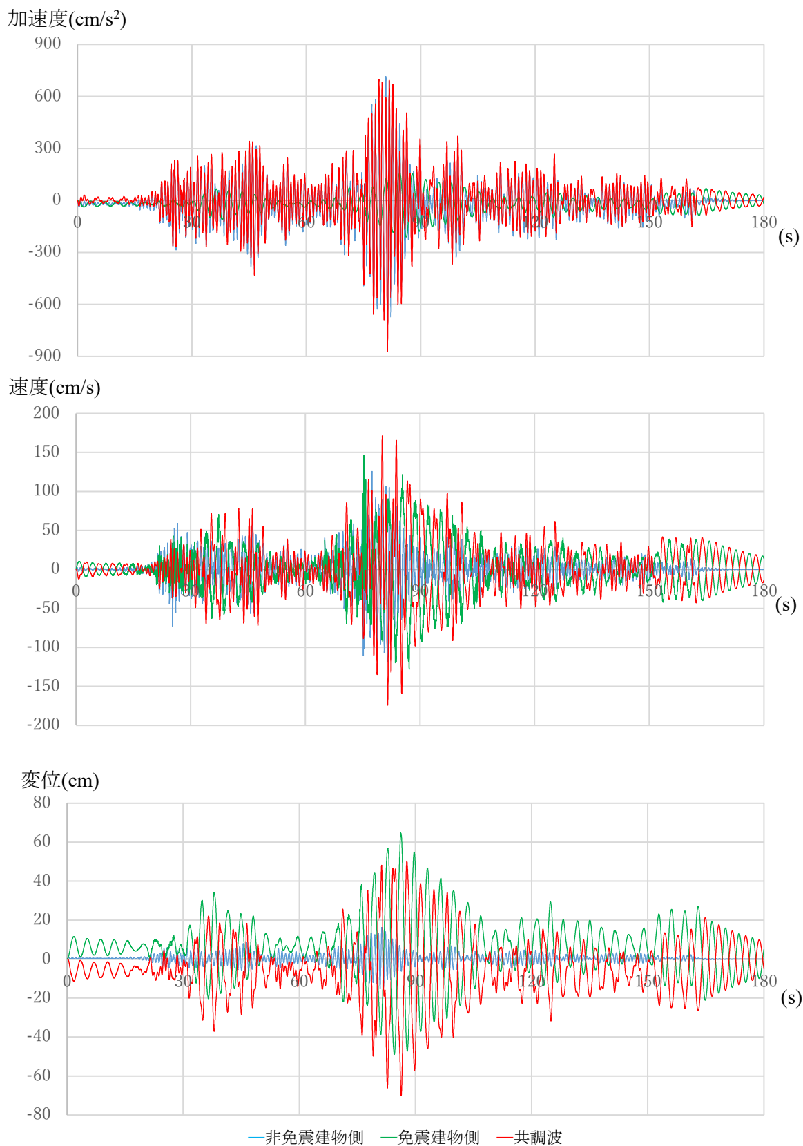
図 13-3 東北地方太平洋沖地震 NS 方向 建物応答波形
