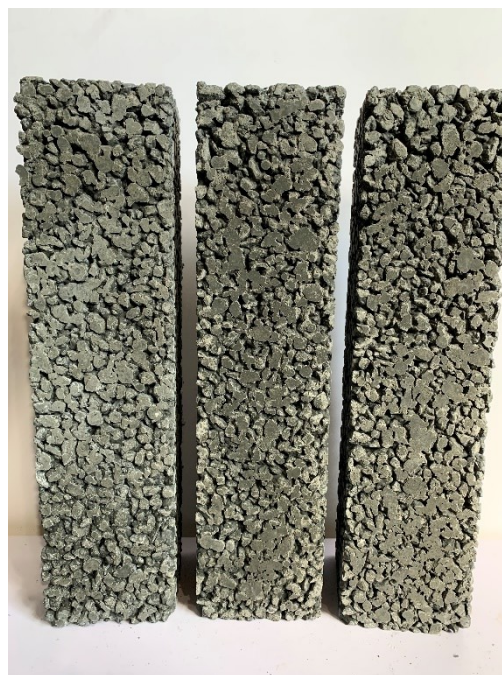
b) 角柱試験体 ( V_R=20\% )
