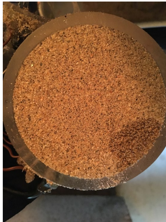
図 4-7 左図 : Ex.8 における z=3\text{ cm} の断面図 (水みちなし), 右図 : Ex.5 における z=8\text{ cm} の断面図 (水みちあり)
