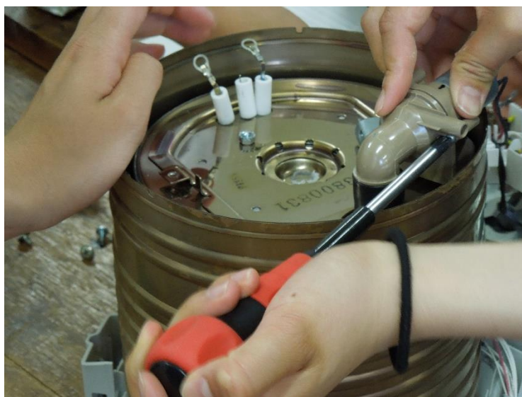
図 4.1 電気ポットの分解の様子
