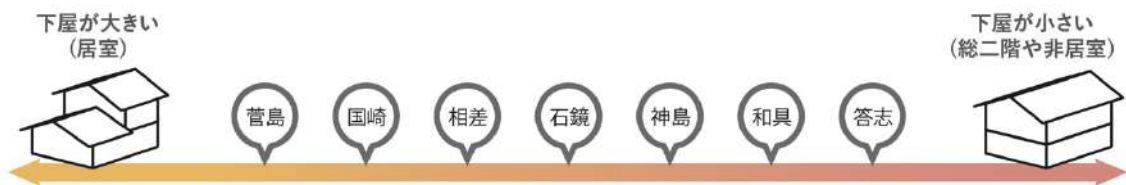
図 5-3-10 二階建て 下屋の大きさによる位置付け
