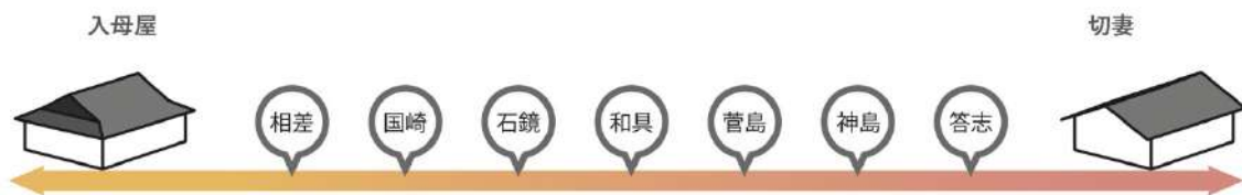
図 5-4-10 屋根形式「入母屋」と「切妻」の比重による位置付け
