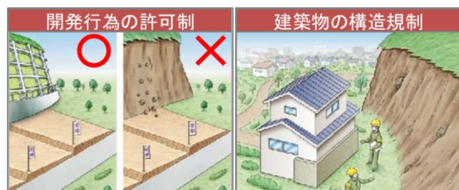
図 3 土砂災害特別警戒区域における開発行為の規制状況 (国土交通省 HP における「土砂災害防止法の概要」を基に作成)
