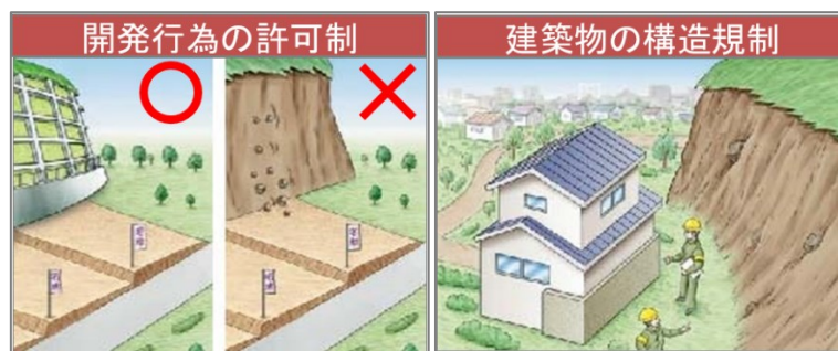
図 2-1 土砂災害特別警戒区域における開発行為の規制状況 (国土交通省 HP における「土砂災害防止法の概要」を基に作成)
