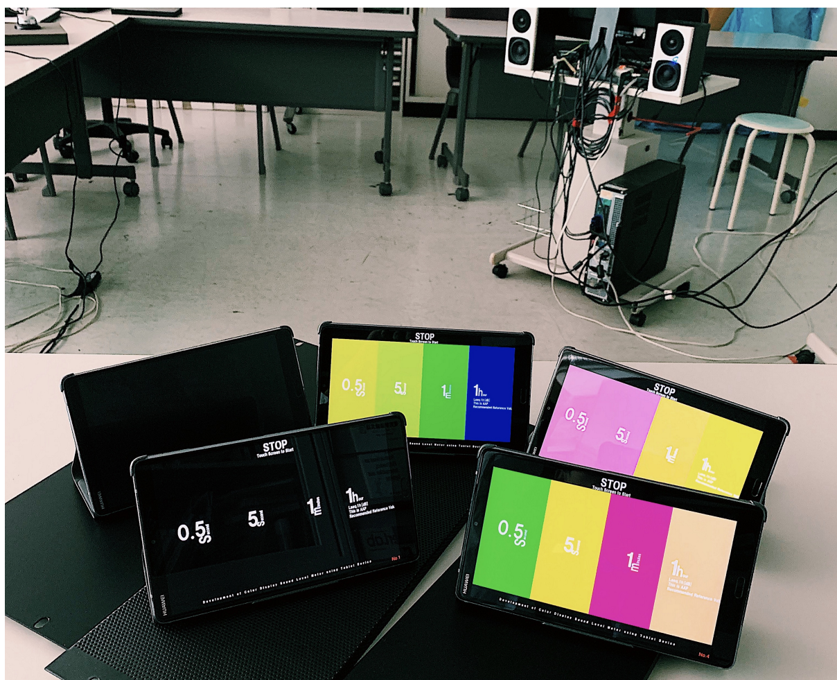
図 3.2: 複数タブレットにインストールされた色相騒音計アプリケーション
