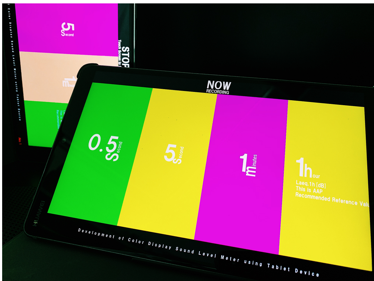
図 3.1: 1画面に異なる時間平均を同時表示する色相騒音計アプリケーション
