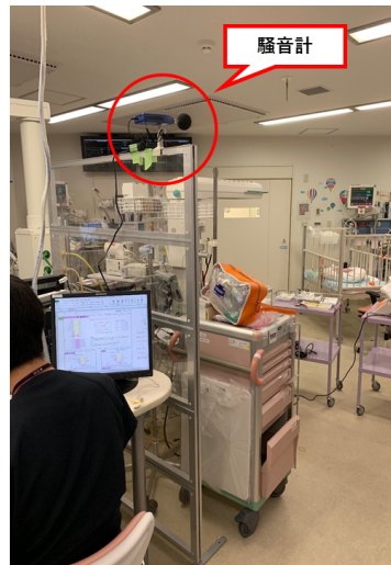
図 2.3: 騒音計による收音の様子
