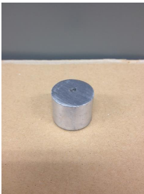
図 2.26 アルミ合金台座 (直径 30mm, 高さ 20mm)
