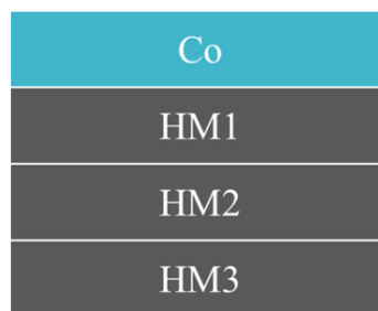
図 3. 19 SOC の切り替えを行ったモデルの概念図。本研究では HM1~3 はそれぞれのモデルにおける 5d 重金属 Ta, W, Re, Os, Ir, Pt に対応する。
