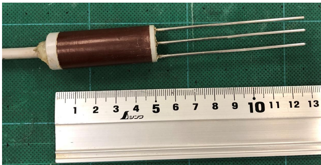
図 2-4 使用した TDR プローブ Figure 2-4 Schematic of a TDR probe
