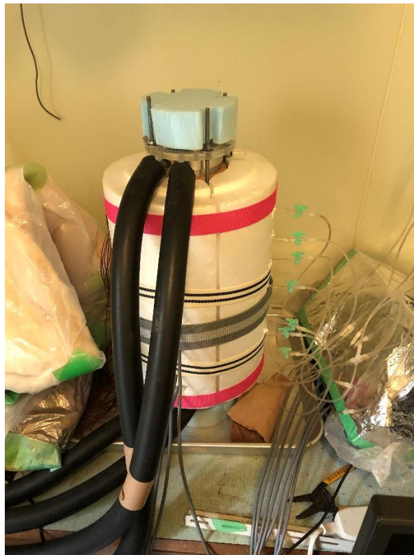
図 2-15 断熱材を巻いたカラムの写真
