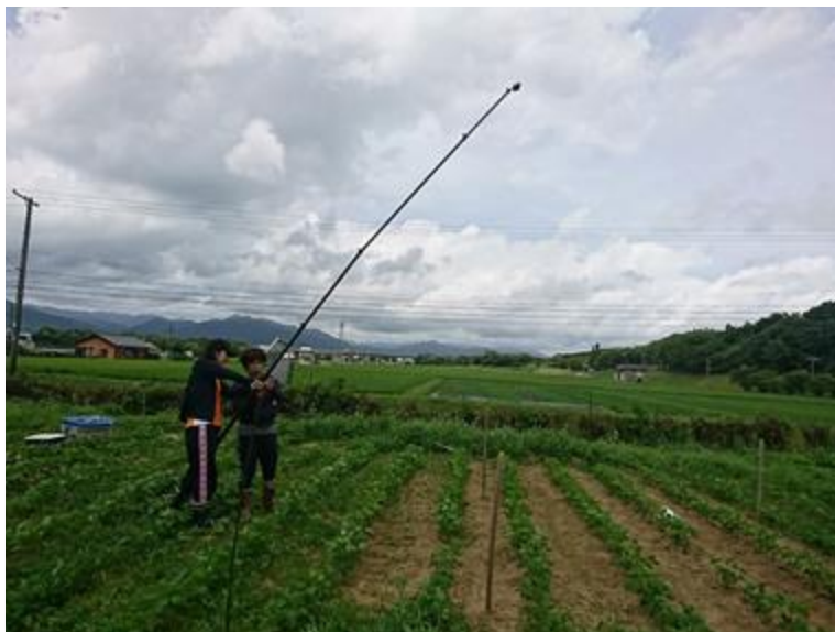
図 2.8 長尺デジカメ棒による空中撮影風景
