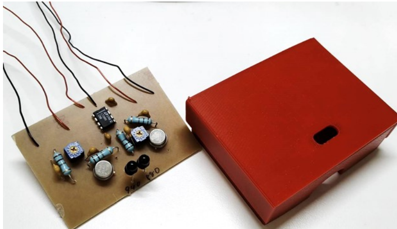
図 3-2-5 開発した自作センサユニット
