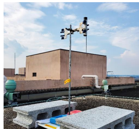
図 18. 屋上での日射量測定の様子
