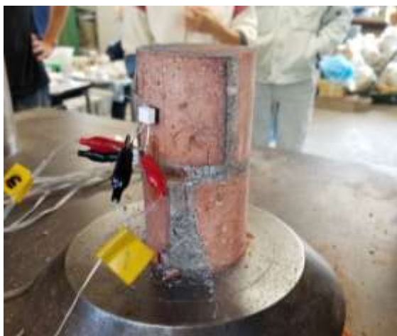
図 4-3-1 組積体圧縮試験の様子
