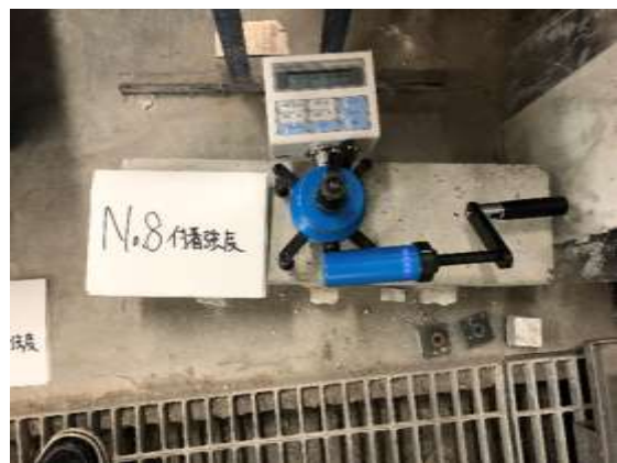
図 2-4-4 建研式付着試験機
