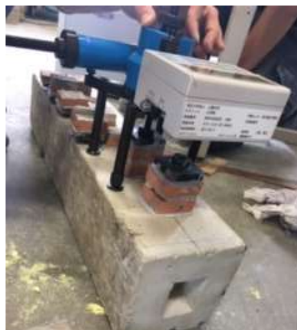
図 4-3-2 付着強度試験の様子
