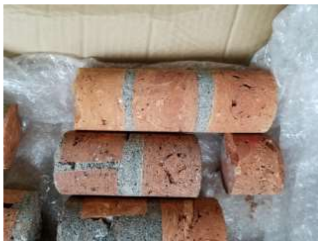
図 2-4-5 構造躯体からコア抜きされた試験材料
