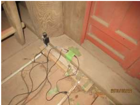
図 3-4-9 天井の加速度計設置状況
