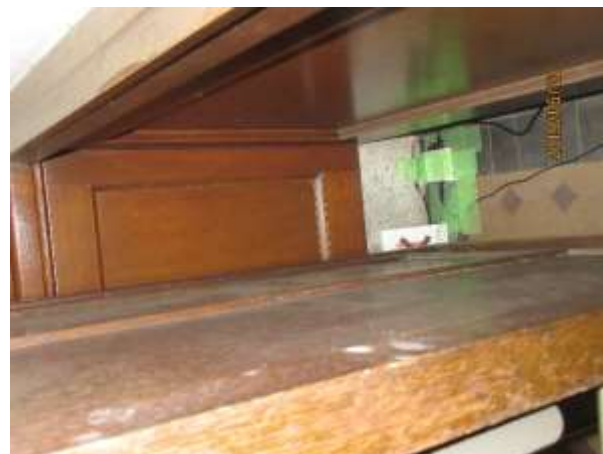
図 3-4-6 1 階の加速度計設置状況
