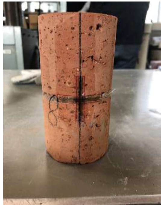
図 2-4-2 煉瓦組積体圧縮試験
