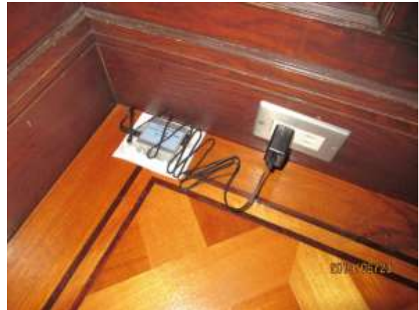
図 3-4-8 2 階の加速度計設置状況
