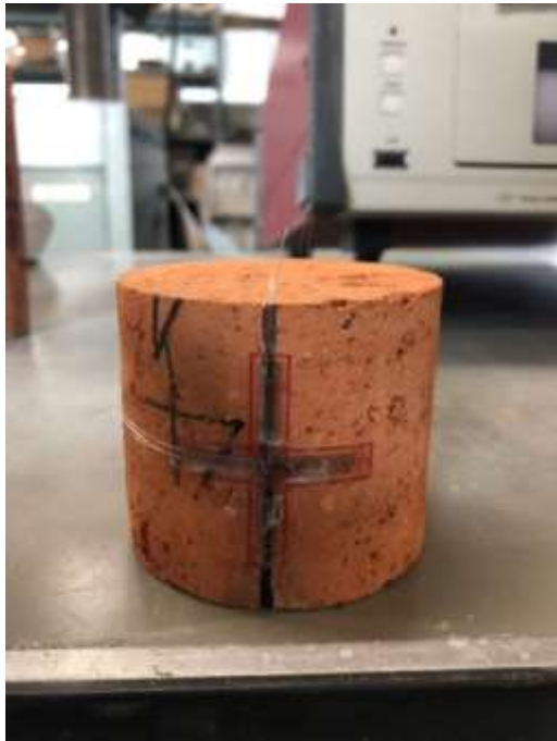
図 2-4-1 煉瓦単体圧縮試験体
