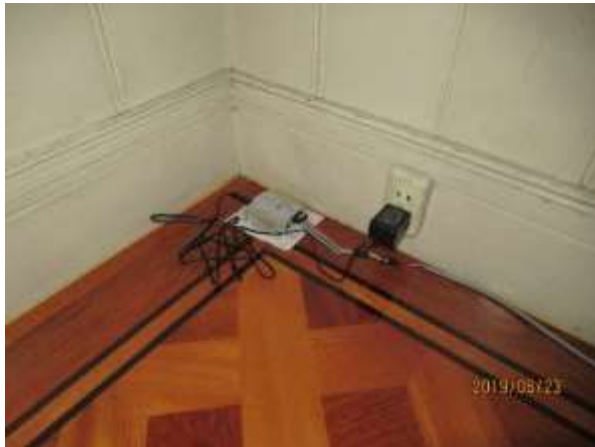
図 3-4-7 2 階の加速度計設置状況
