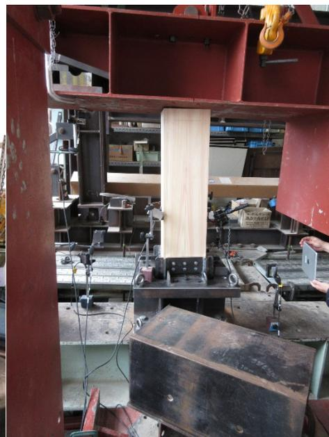
写真 2.2-7 レーザー変位計設置状況②
