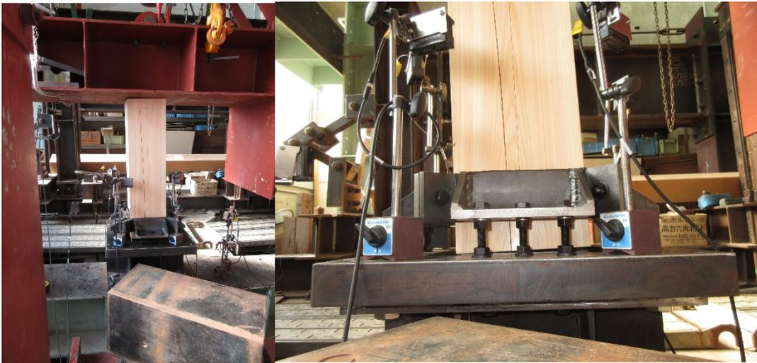
写真 2.2-9 試験時の様子(柱脚上部設置型)
