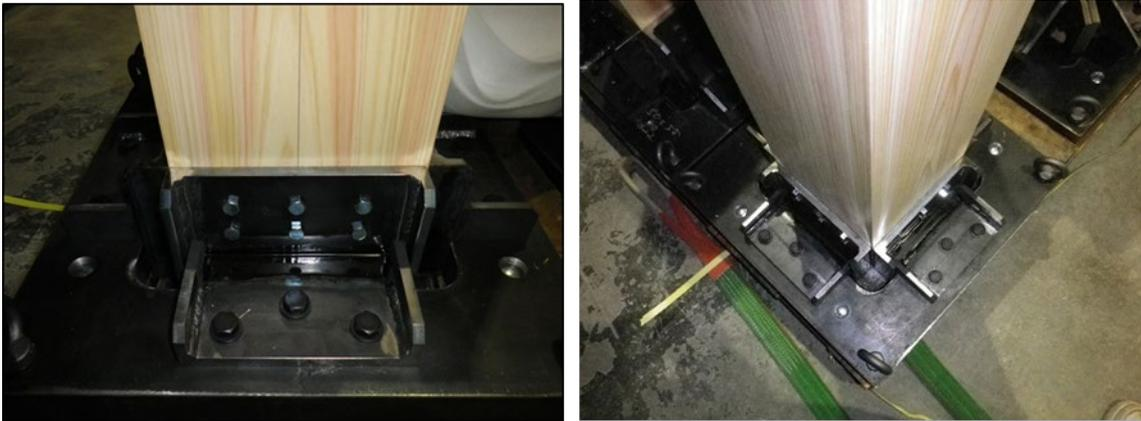
写真 2.2-4 柱脚下部設置型
