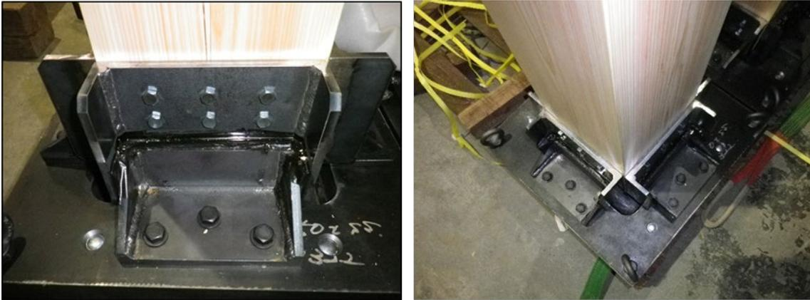
写真 2.2-3 柱脚設置型
