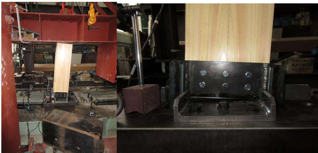
写真 2.2-11 試験時の様子(柱脚下部設置型)
