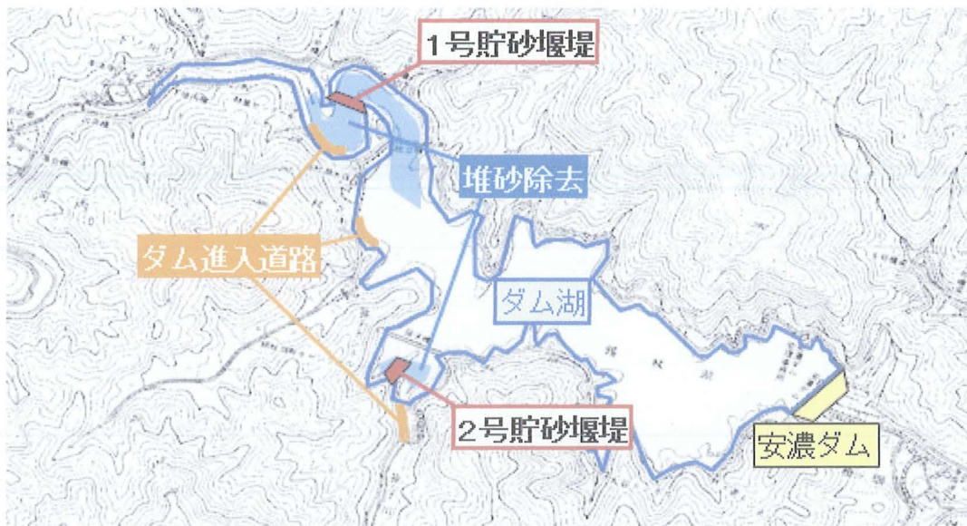
図 2-1 安濃ダムと貯砂堰堤 (出典：東海農政局)
