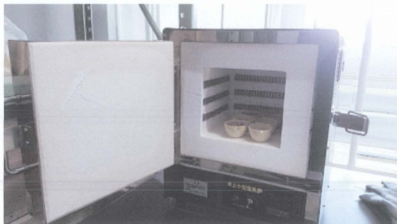
図 3-1 卓上小型電気炉
