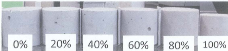
図 5-6 細骨材 2+堆砂 1 のセメントモルタル
