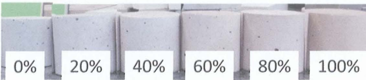
図 5-7 細骨材 1+堆砂 2 のセメントモルタル
