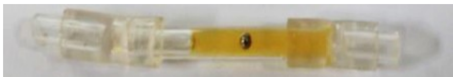
Fig.2-4 ゲル化時間測定用キャピラリーチューブ
