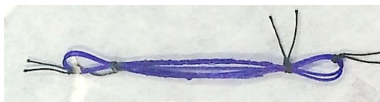
Fig.2-4 作製した人工靭帯
