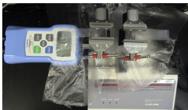
Fig.2-2 弾性率測定装置
