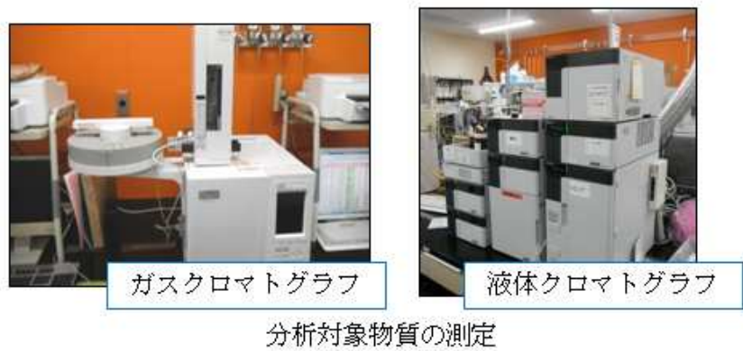
図 1.2 食品中の化学物質分析の操作・使用機器の例
