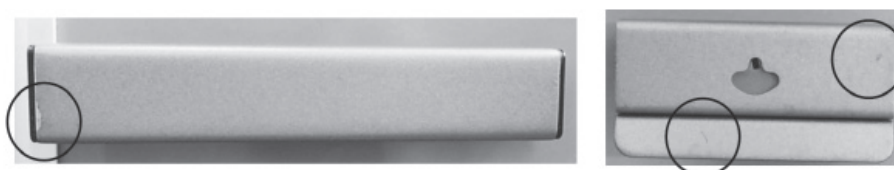
図3 1年間の使用による抗菌塗装済ドア把手の塗装表面の傷
