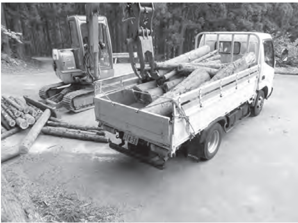
写真1. 美杉木材市場へ木質バイオマスを出荷するための積材作業
