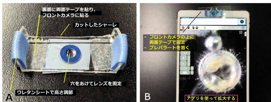
図2. ミエル1mmの試作品(A)とタブレットに取り付けた状態(B).
