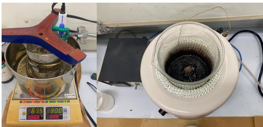
Fig. 2-4 オイルバススターラーと 1 L ビーカーとマントルヒーターでの分解
