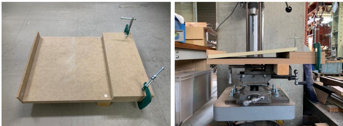
写真 3.1 傾き調整治具(板の枚数と位置によって傾きを調節できる)
