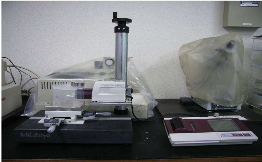
Fig.2.22 触針式表面粗さ計（Surftest SJ-400）の外観
