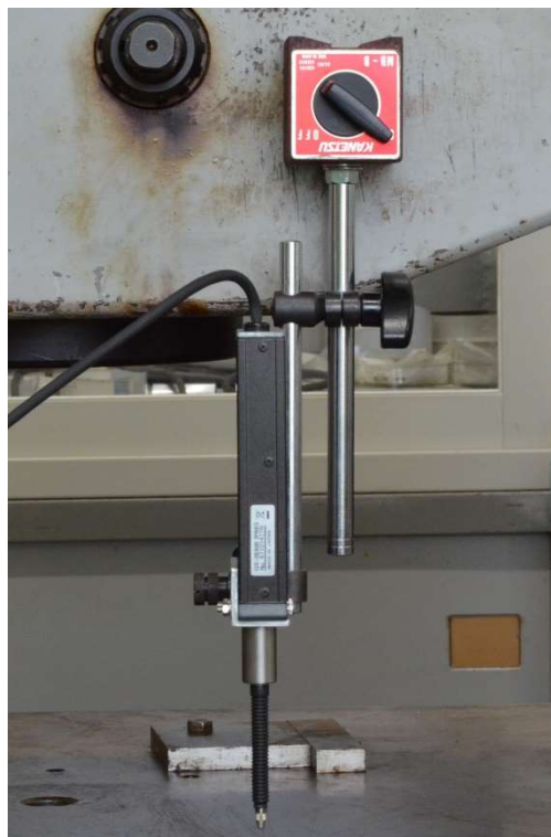
Fig.2.18 変位測定機（ONO SOKKI 製 LINEAR GAUGE SENSOR GS-3830B）
