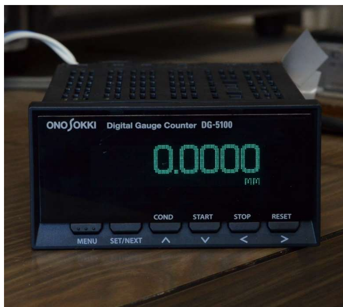
Fig.2.19 デジタルゲージ (ONO SOKKI 製 Digital Gauge Counter DG-5100)
