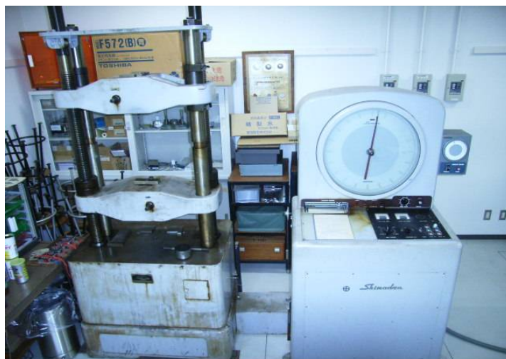
Fig.2.16 万能試験機（島津製作所製，REH-50 型）
