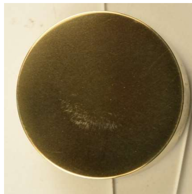
Fig.3.17 圧縮後工具表面 (TiN, Tool-1, C1020-O, e_c=18\% )
