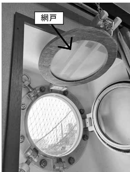
図5 換気確保のための舷窓網戸設置の様子（学生教室兼食堂）
