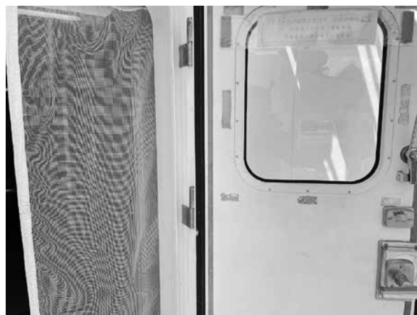
図6 換気確保のための船内外出入口網戸設置の様子（長船首楼甲板後部）
