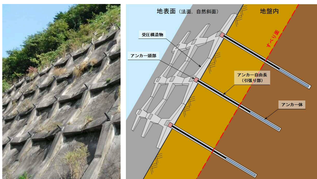
図-1.1 アンカーの模式断面図
