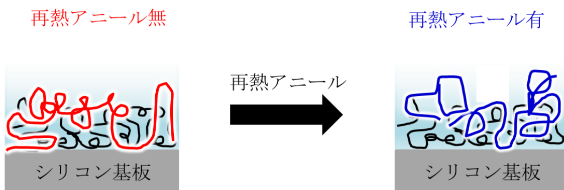
Figure 3-10. 再熱アニールをかけることによる分子鎖の移動の模式図
