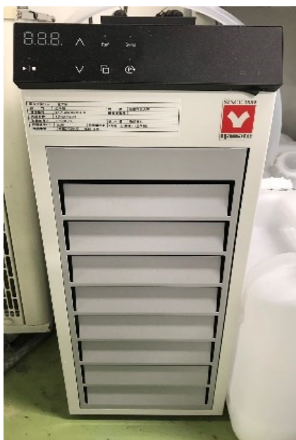
Fig. 11 外部密閉系冷却水循環装置
