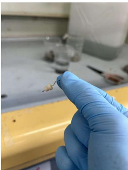
図 3-3(b) 充放電後の正極集電体の様子
