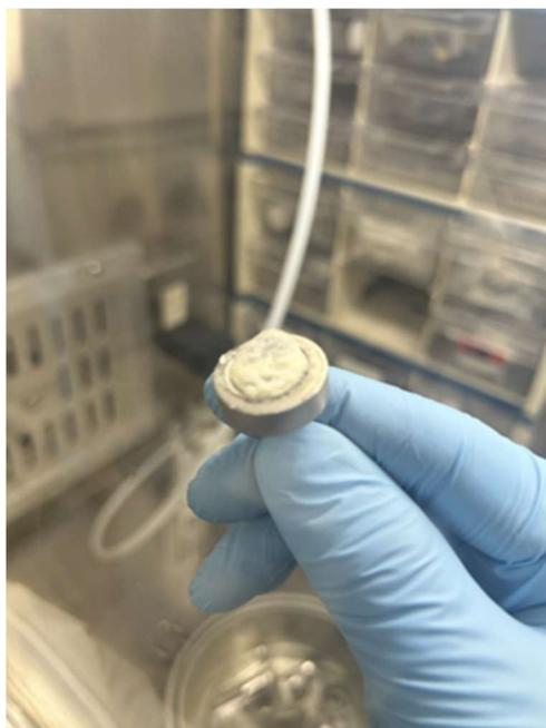
図 3-2(f) 電流密度  $5.0 \text{ mA/cm}^2$  でのサイクル後のリチウム金属表面
