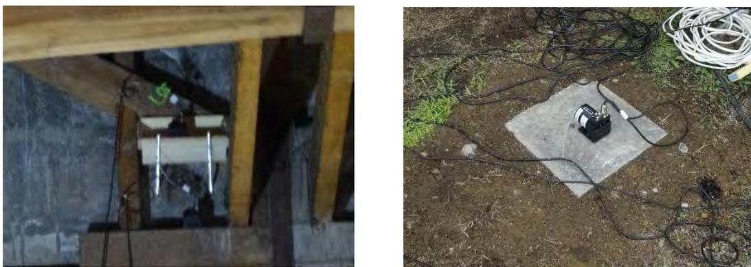
写真 2.2.1 センサー設置状況(左：木柱と石壁、右:地盤)
