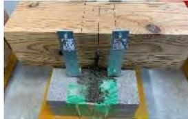
図6 接合部試験体
