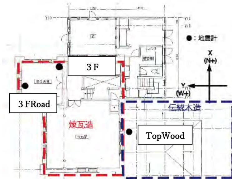
図 3.4.3 3階(木造部分は小屋組み) 加速度計位置
