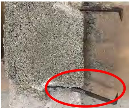
写真 2.5.3 下側かすがいの曲げ変形
