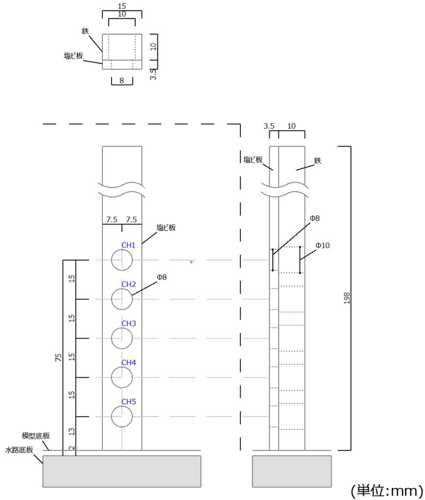
図 2-6 波圧計設置器具の三面図
