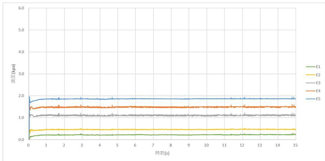
图 B-2-28 時刻歷波压 (模型(f)、E 列)
