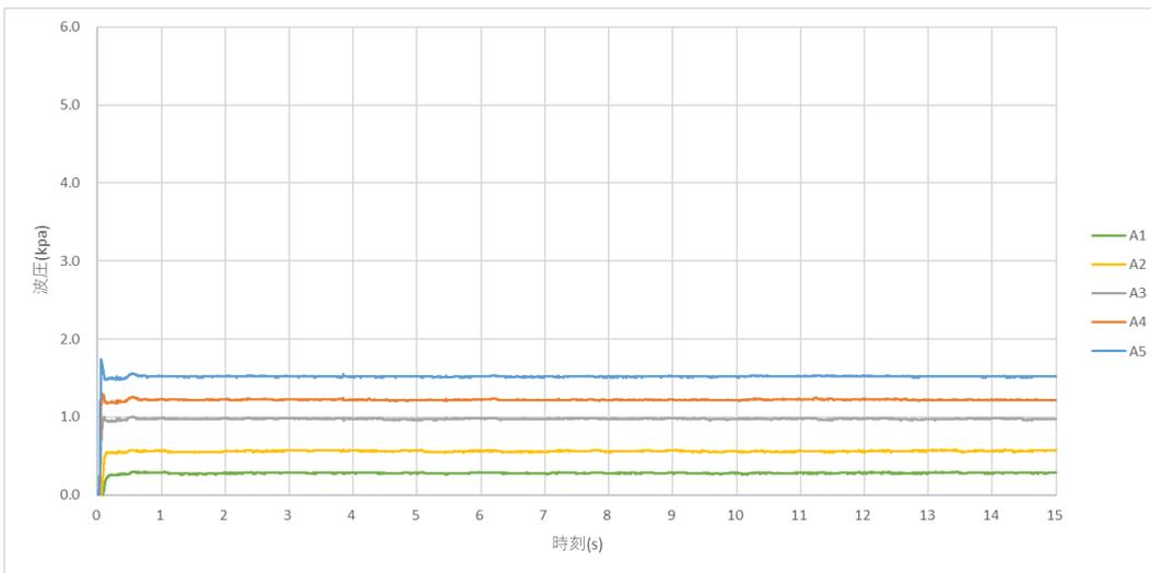
图 B-2-6 时刻歷波压 (模型(b)、A 列)
