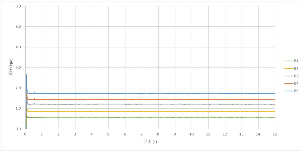
图 B-2-17 时刻歷波压 (模型(d)、B 列)
