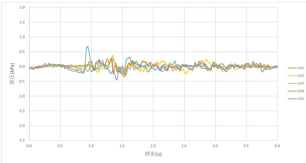
图 A-4 時刻歴波压 (模型(a)、四回目)
