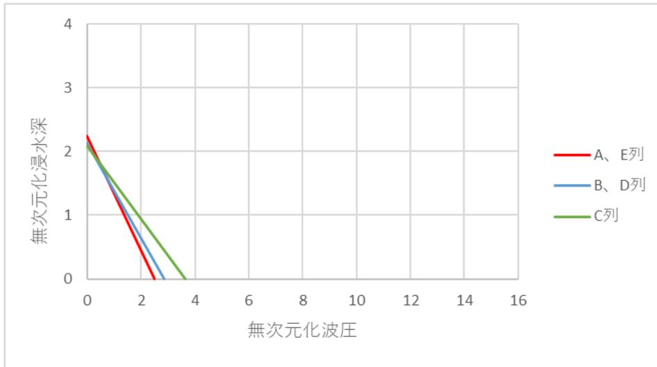
图 4-13-3 近似無次元化波压分布 (定常・模型(c))
