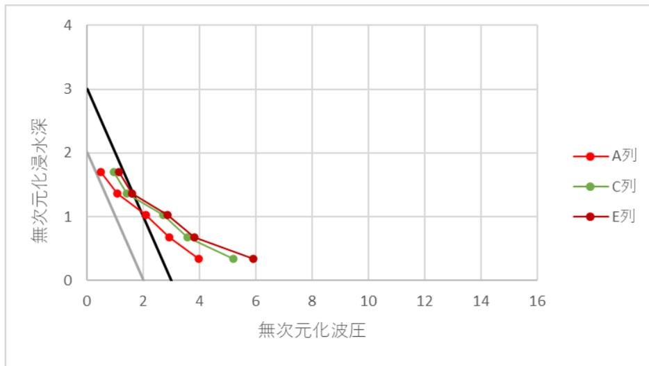
図 3-11-8 無次元化波圧分布（模型(h)、衝撃ケース）
