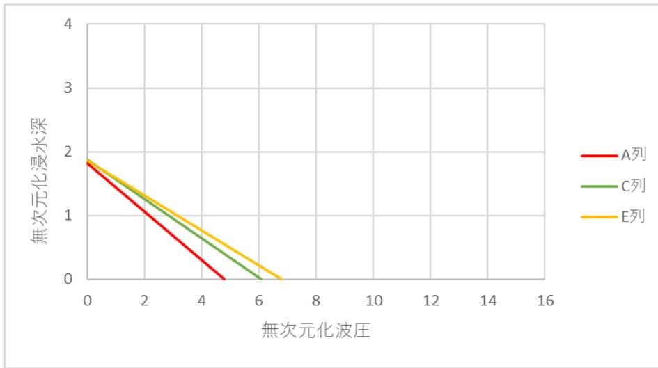
图 4-12-8 近似無次元化波压分布（衝擊・模型(h)）
