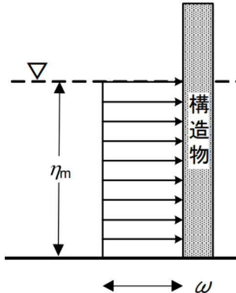
図 1-6 等圧分布波圧  $\omega$  を受ける構造物
