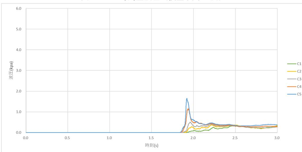
图 B-1-23 時刻歷波压 (模型 (e)、C 列)
