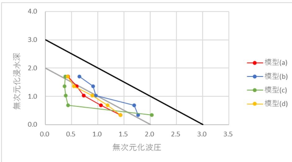
图 2-9-2 無次元化波圧分布 (模型(a)~模型(d))
