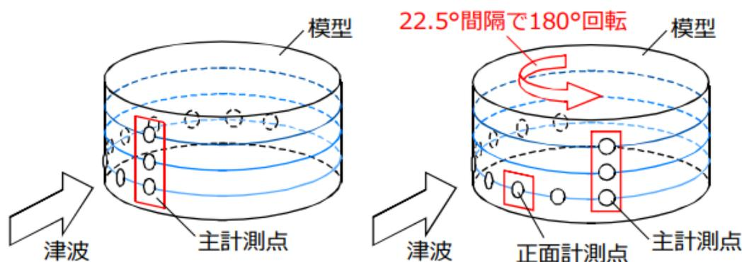
図 1-14 波圧計測箇所
