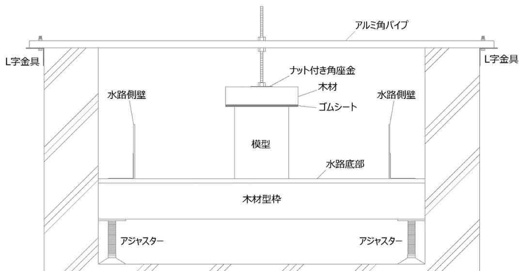
図 2-4 模型固定装置の概略図
