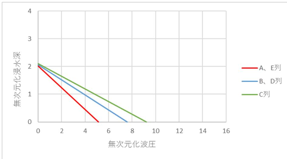
图 4-12-4 近似無次元化波压分布（衝擊・模型(d)）
