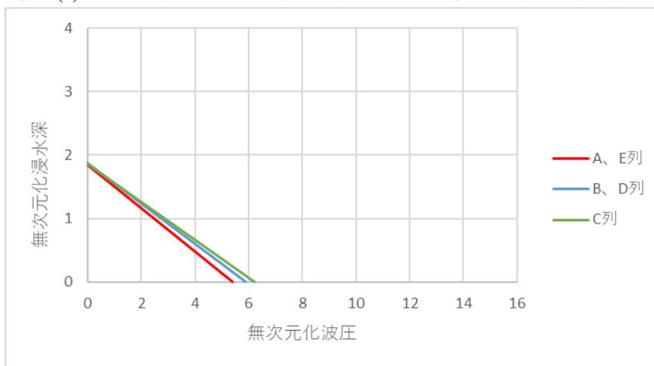
図4-12-1 近似無次元化波圧分布（衝撃・模型(a)）
