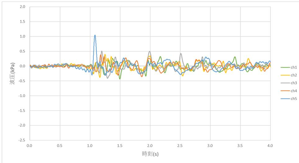
图 A-31 時刻歷波压 (模型(f)、三回目)
