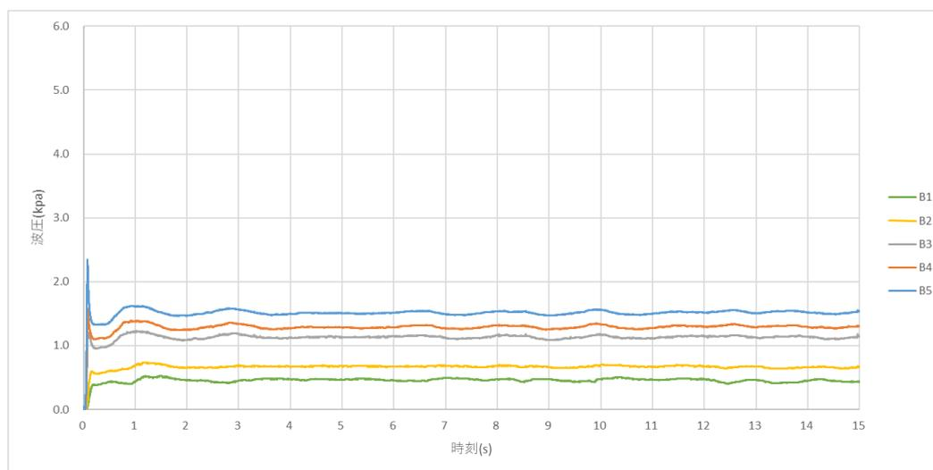
图 B-2-22 時刻歷波压 (模型(e)、B 列)
