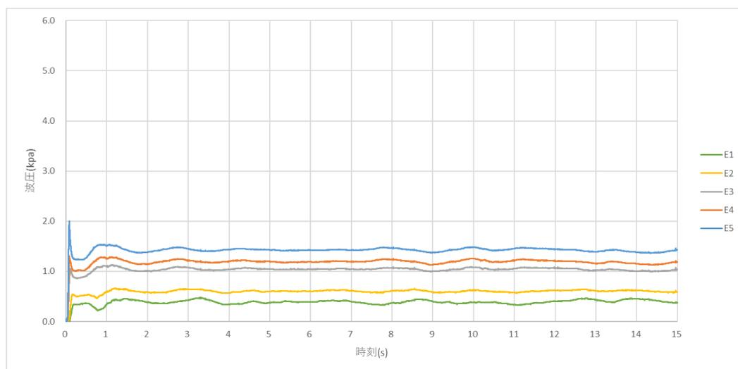
图 B-2-25 時刻歷波压 (模型(e)、E 列)
