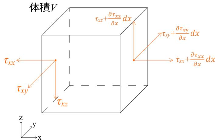
図 C-4 粘性応力 (x 面のみ記載) を受ける微小直方体
