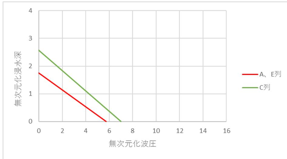
图 4-12-6 近似無次元化波压分布（衝擊・模型(f)）
