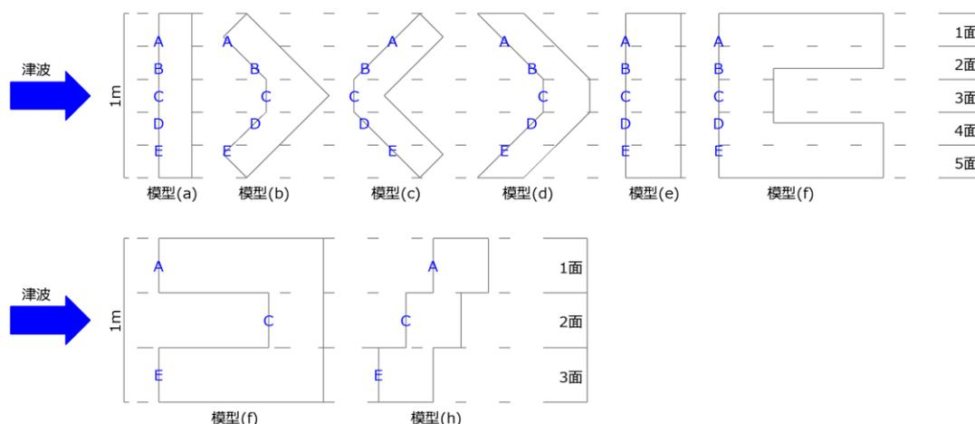
図4-11 津波荷重算定用模型
