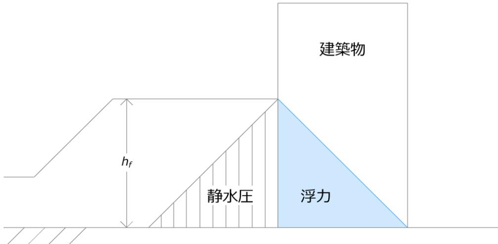
図 1-3 津波先端部での浮力
