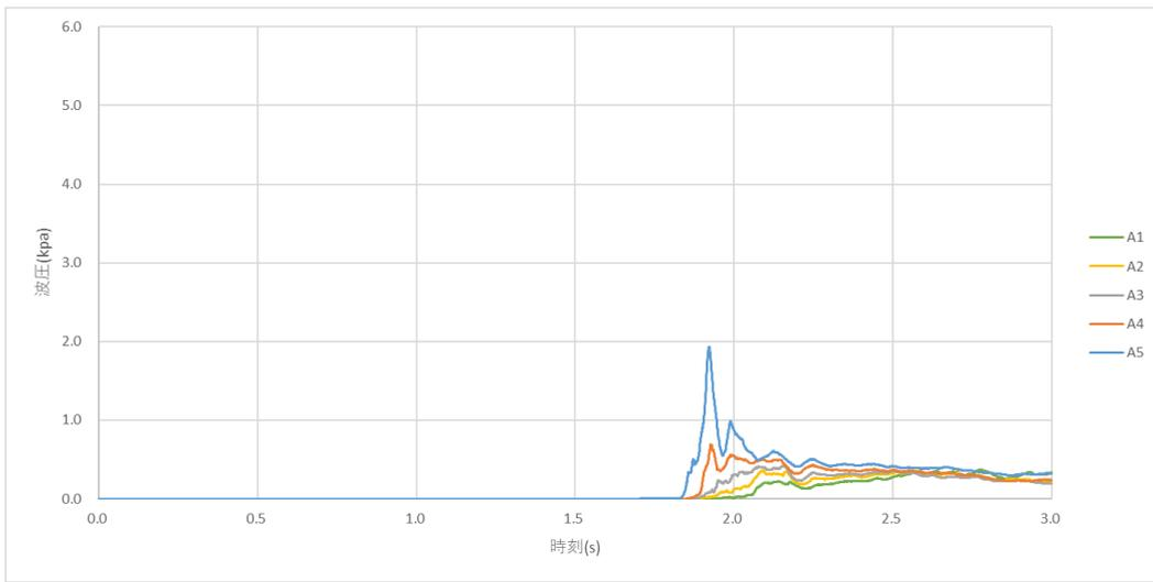
图 B-1-6 時刻歴波压 (模型(b)、A 列)
