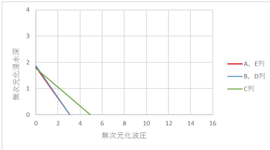
图 4-12-3 近似無次元化波压分布（衝擊・模型(c)）
