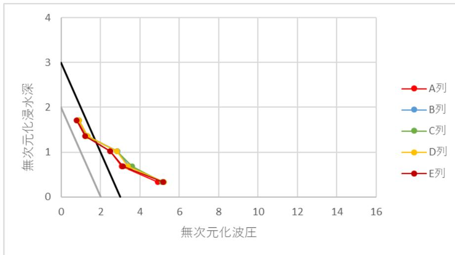
図 3-11-7 無次元化波圧分布（模型(g)、衝撃ケース）
