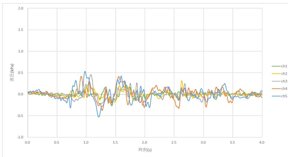
図 A-1 時刻歴波圧 (模型(a)、一回目)
