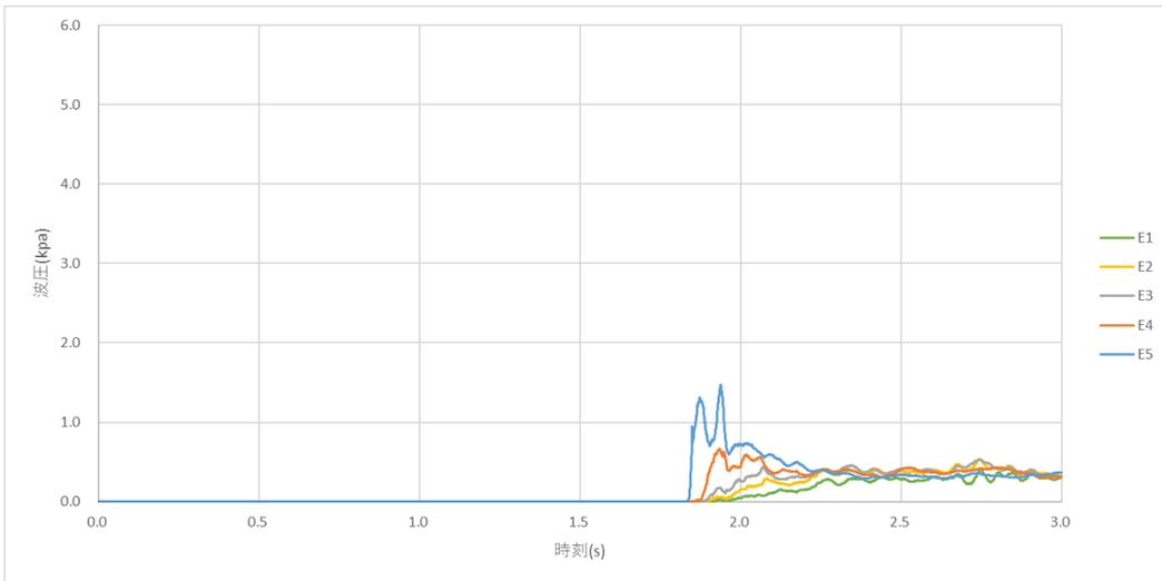
图 B-1-10 時刻歷波压 (模型 (b)、E 列)
