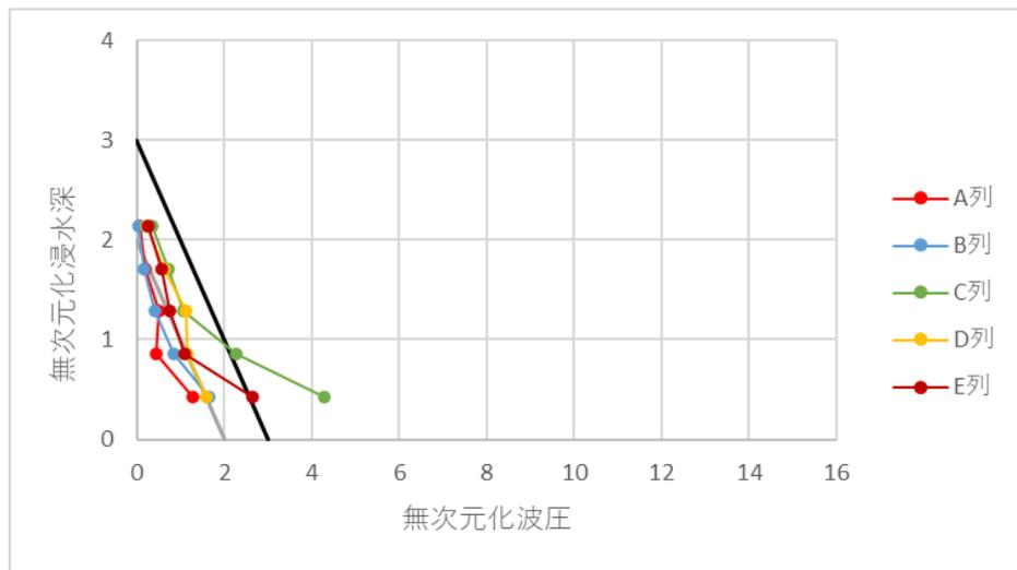
图 3-8-3 無次元化波压分布 (模型(c))
