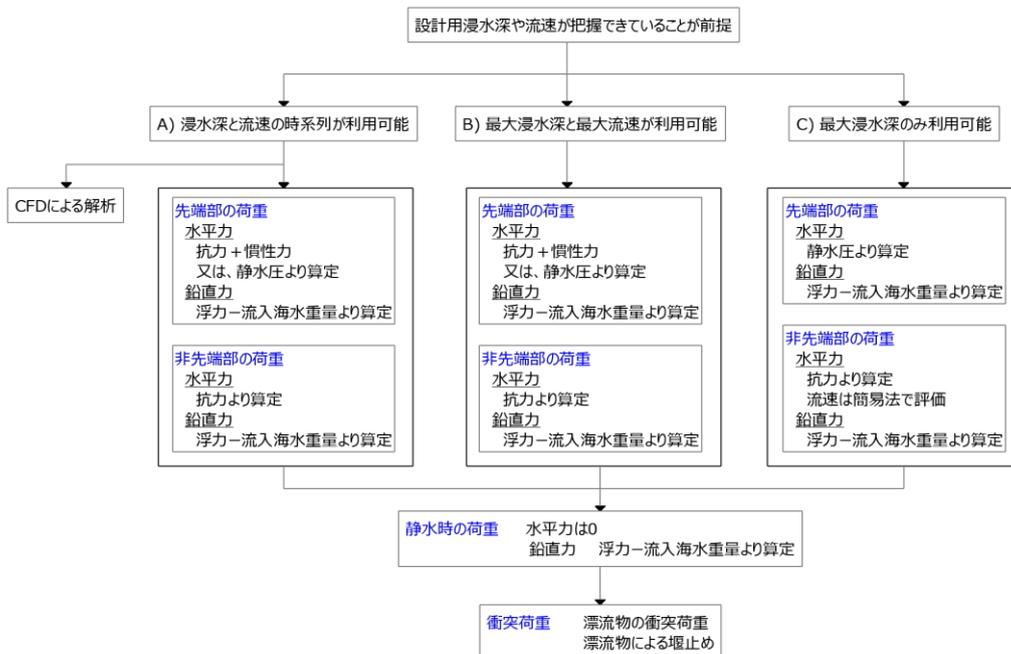
図 1-2 津波荷重算定フロー図
