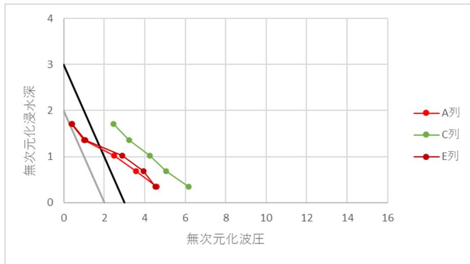
図 3-11-6 無次元化波圧分布（模型(f)、衝撃ケース）
