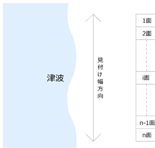
図 4-10 建築物の見付け幅方向の分割
