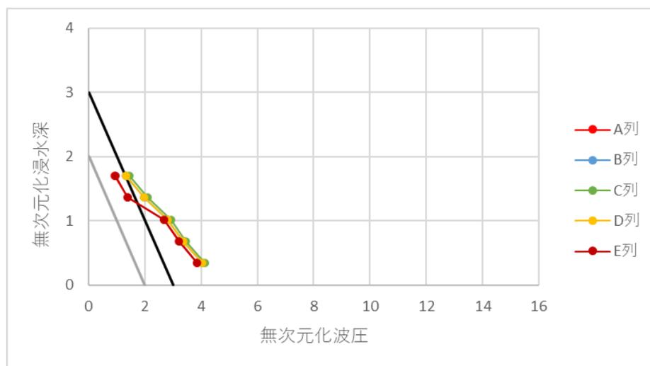
図 3-12-4 無次元化波圧分布（模型(d)、定常ケース）
