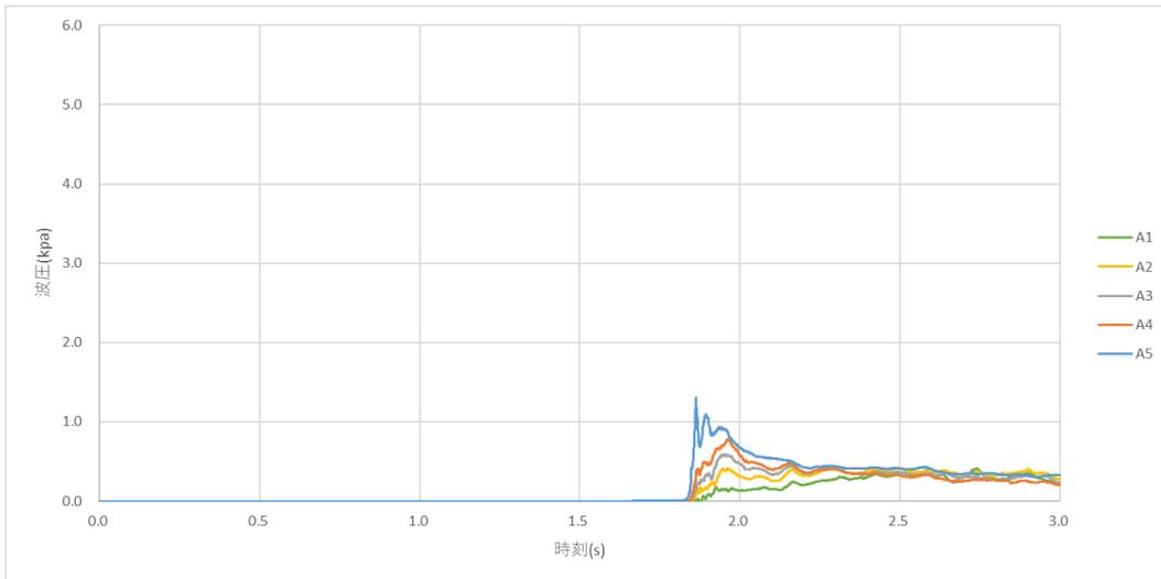
图 B-1-16 時刻歴波压 (模型(d)、A 列)
