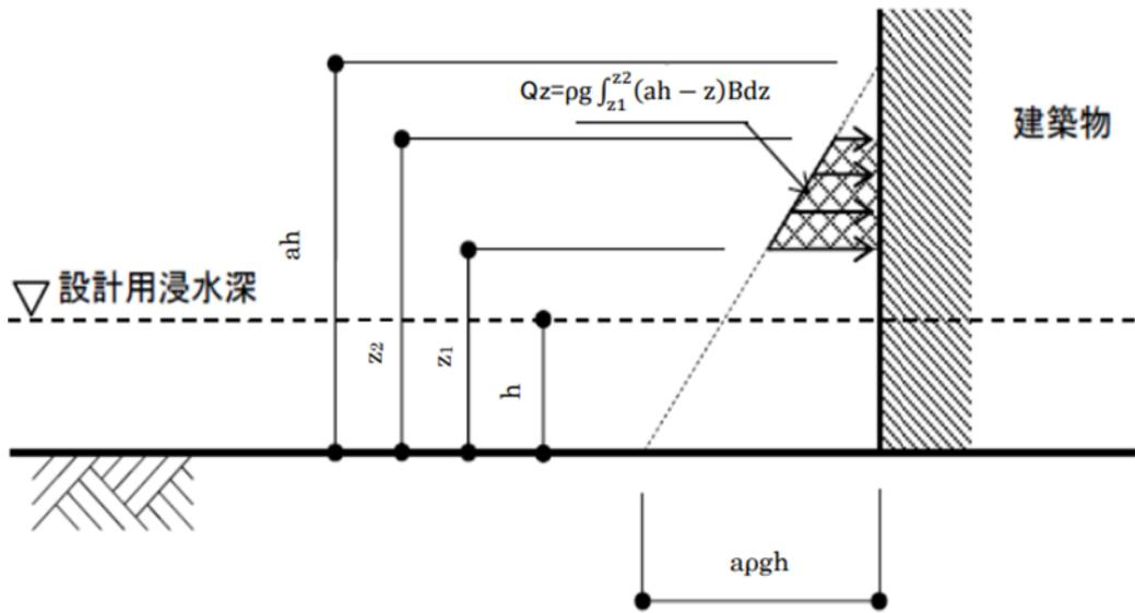
図 1-1 ガイドラインによる津波波力算定方法の概略図
