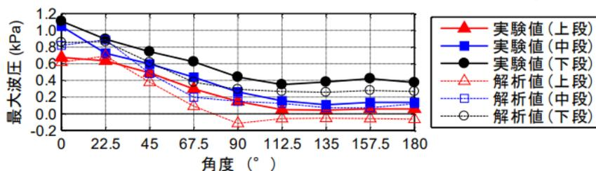
図 1-15 周方向の最大波圧 (貯水高さ  $h_w$  180mm)
