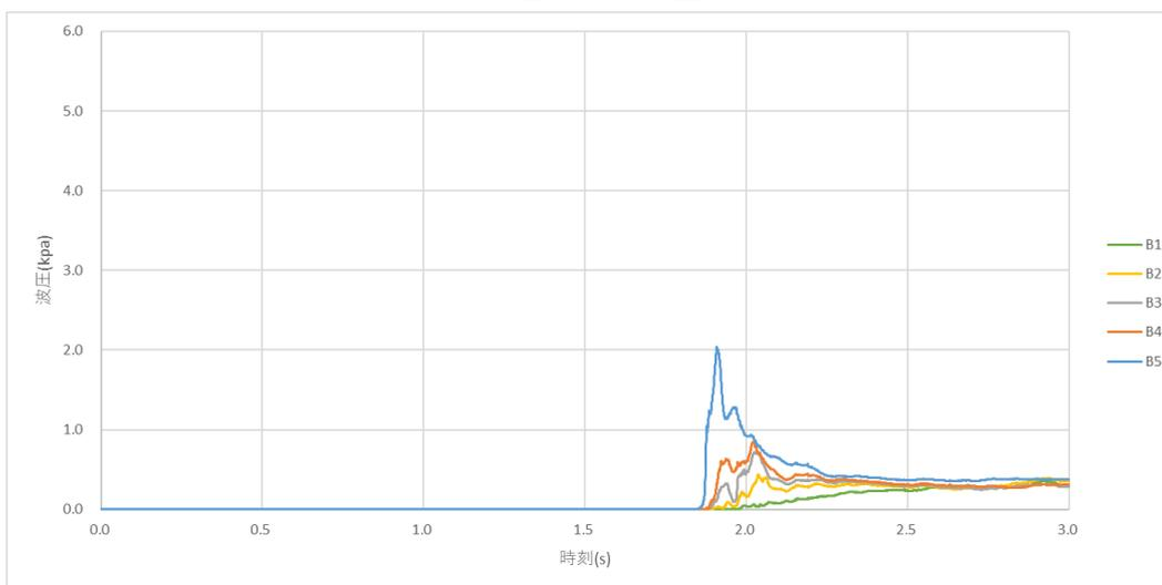
図 B-1-2 時刻歴波圧 (模型(a)、B 列)
