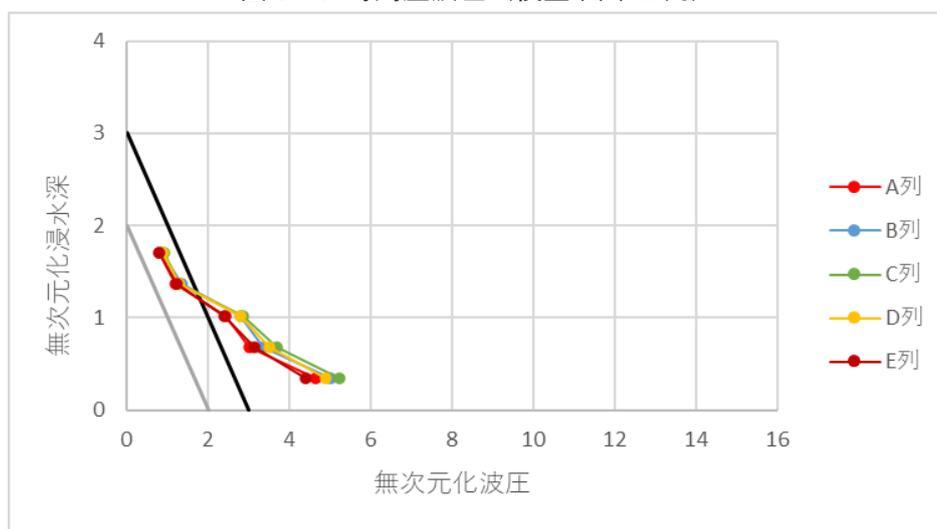
図 3-11-1 無次元化波圧分布 (模型(a)、衝撃ケース)
