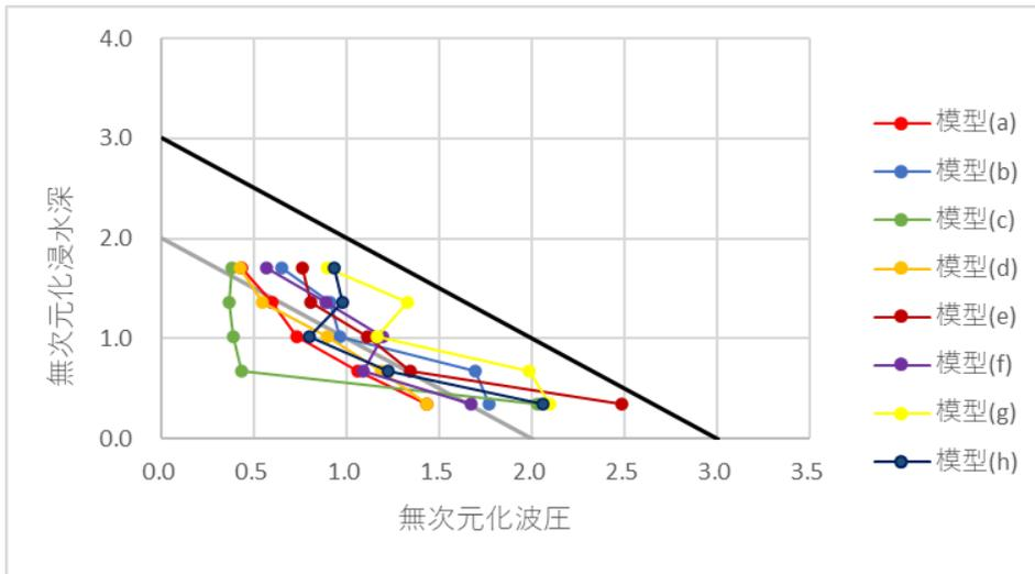
图 2-9-1 無次元化波圧分布 (模型(a)~模型(h))
