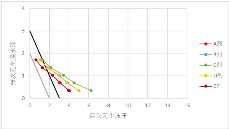
図 3-11-2 無次元化波圧分布（模型(b)、衝撃ケース）
