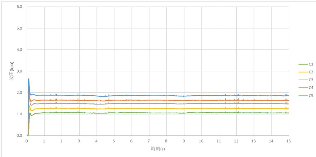
图 B-2-27 時刻歷波压 (模型(f)、C 列)
