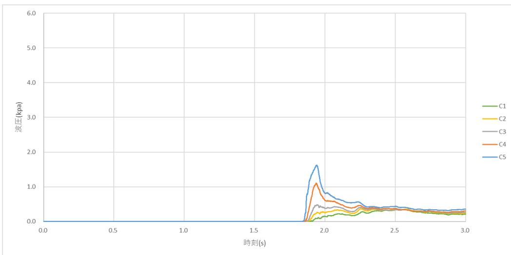
图 B-1-8 時刻歴波压 (模型(b)、C 列)
