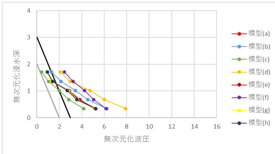
図 4-3 無次元化波圧分布（解析モデル②、衝撃ケース）
