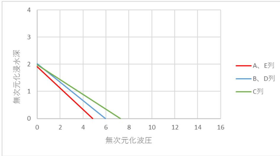
图 4-12-2 近似無次元化波压分布（衝擊・模型(b)）
