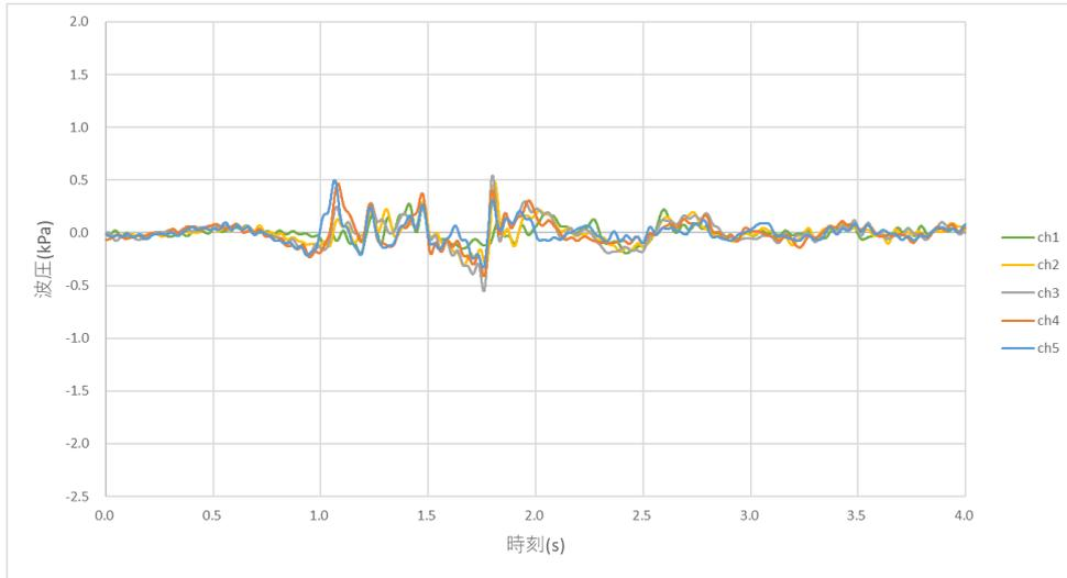
图 A-16 时刻歷波压 (模型(d)、一回目)
