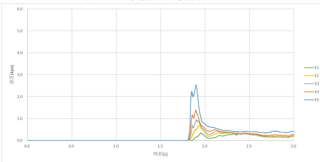
图 B-1-20 時刻歷波压 (模型(d)、E 列)
