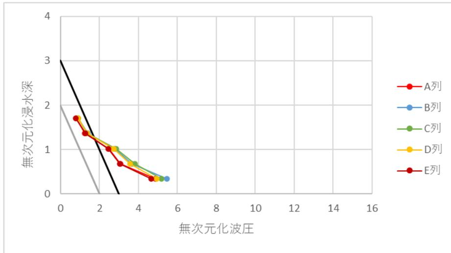
図 3-11-5 無次元化波圧分布（模型(e)、衝撃ケース）
