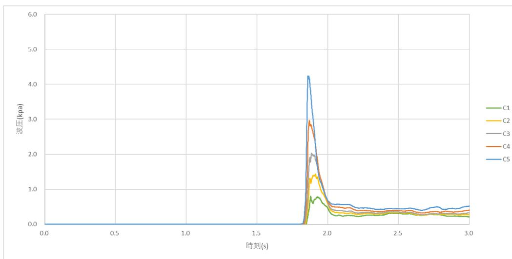
图 B-1-18 時刻歷波压 (模型(d)、C 列)
