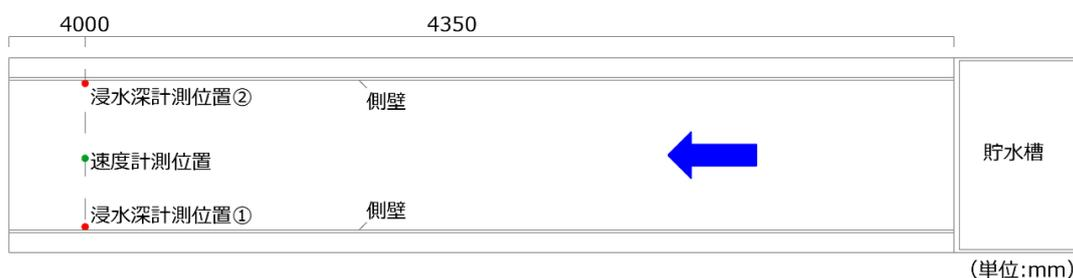
図 3-5 速度、浸水深計測位置
