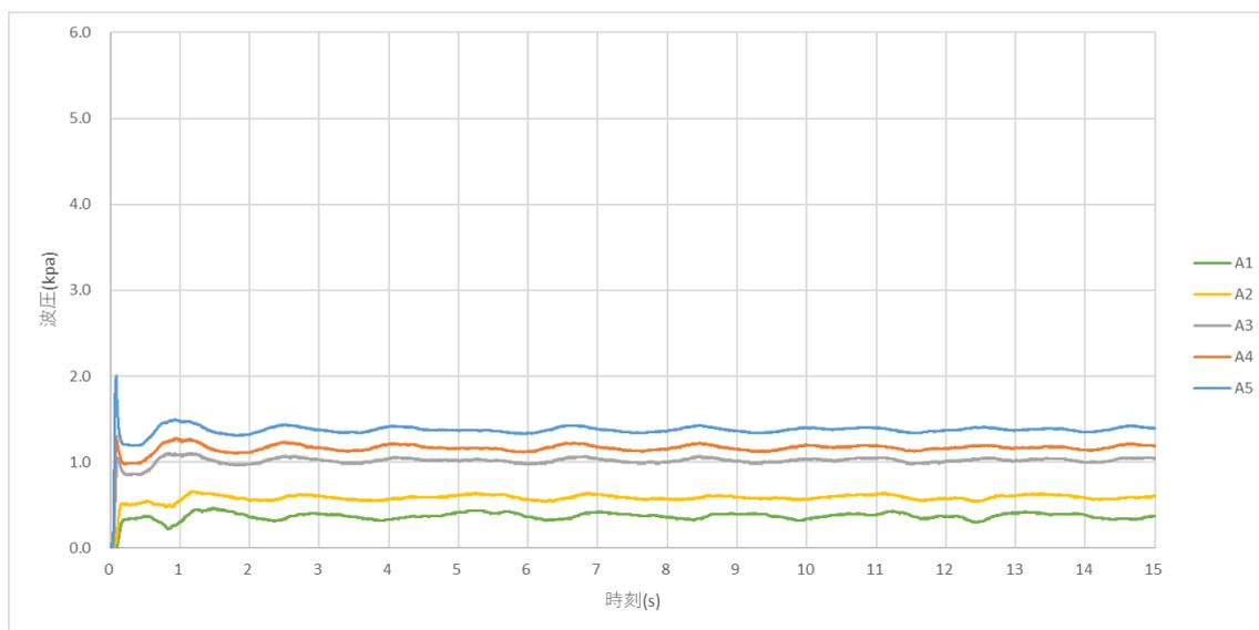
図 B-2-1 時刻歴波圧 (模型(a)、A列)
