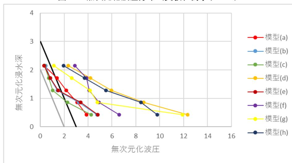
図 4-2 無次元化波圧分布（解析モデル①、衝撃ケース）
