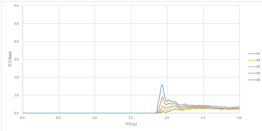
图 B-1-7 時刻歴波压 (模型(b)、B 列)
