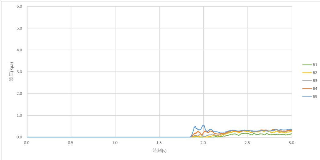
图 B-1-12 時刻歷波压 (模型(c)、B 列)
