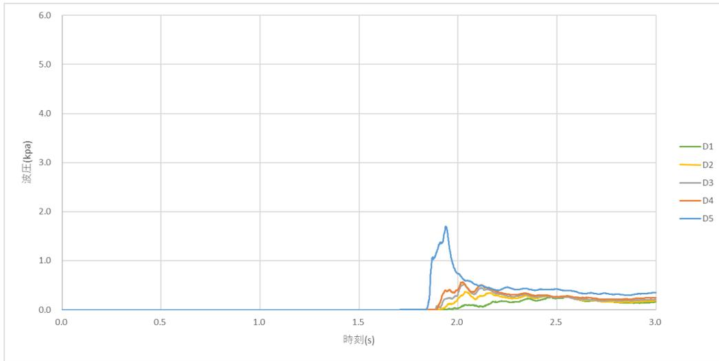
图 B-1-9 時刻歷波压 (模型 (b)、D 列)
