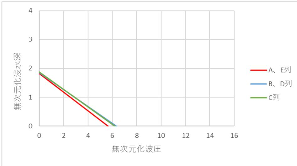
图 4-12-5 近似無次元化波压分布（衝擊・模型(e)）
