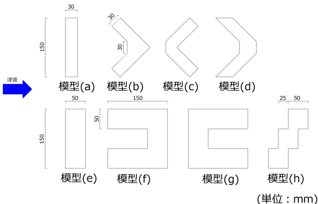
図 1-20 模型平面形状
