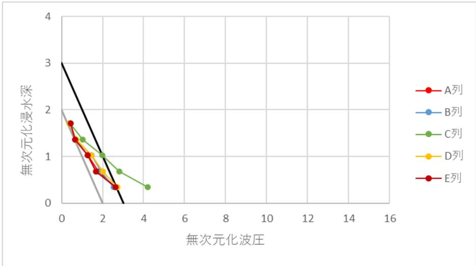
図 3-11-3 無次元化波圧分布（模型(c)、衝撃ケース）
