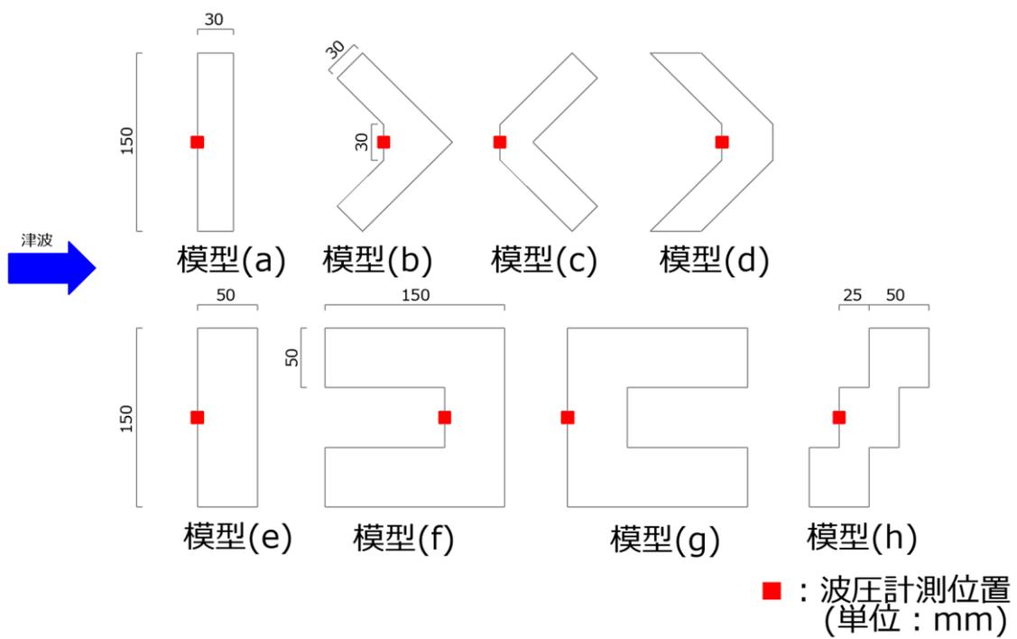
图 2-5 模型平面形状
