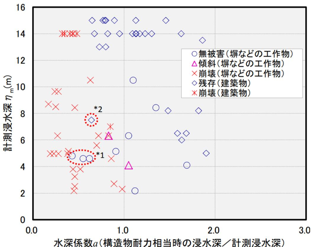
図1-5(a) 計測浸水深と被害程度の関係（遮蔽物がある場合）
