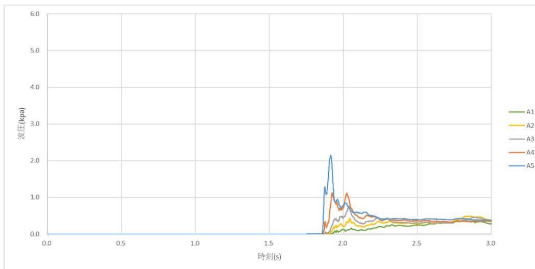
図 B-1-1 時刻歴波圧 (模型(a)、A 列)
