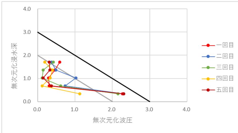
图 2-8-3 無次元化波压分布 (模型(c))
