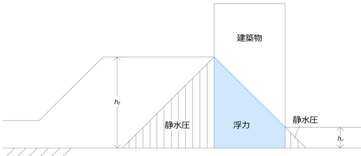
図 1-4 津波先端部での浮力
