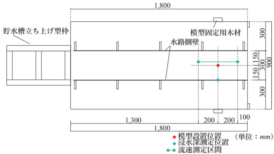
(II) 平面図と計測機器の配置
