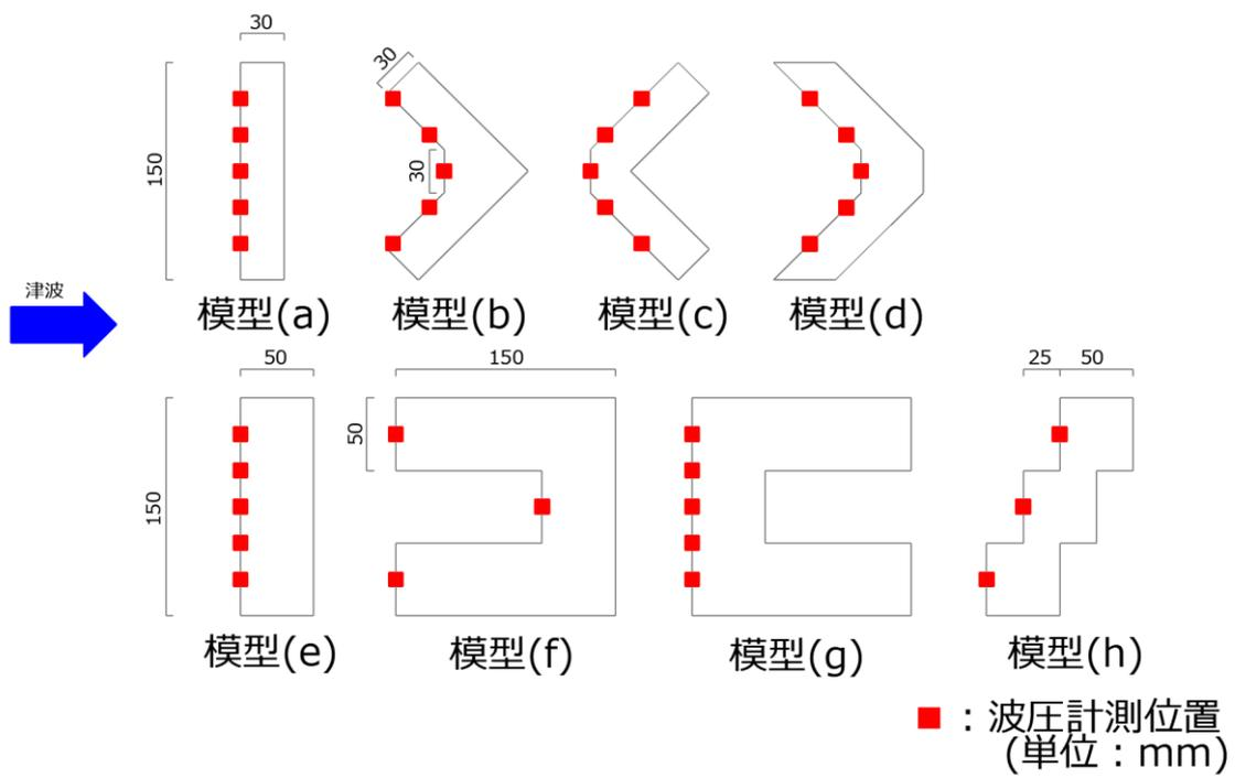
图 3-3 模型平面形状
