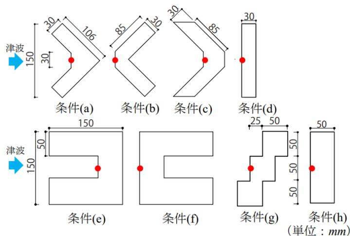
図 1-18 模型平面形状
